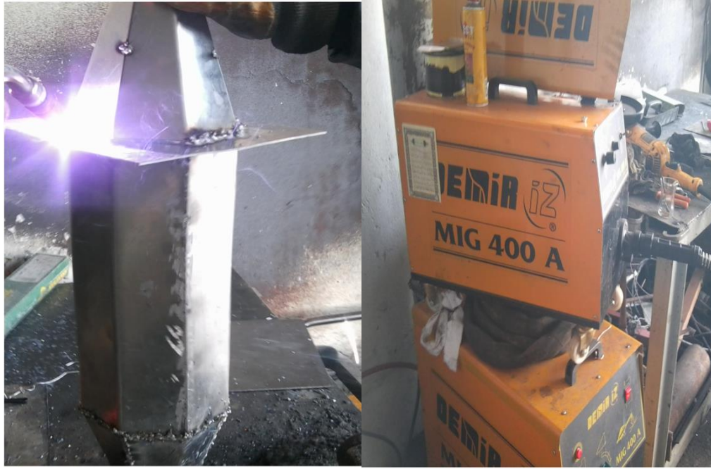
Şekil 2.7. Kaynatma işlemi ve kullanılan MIG kaynağı
