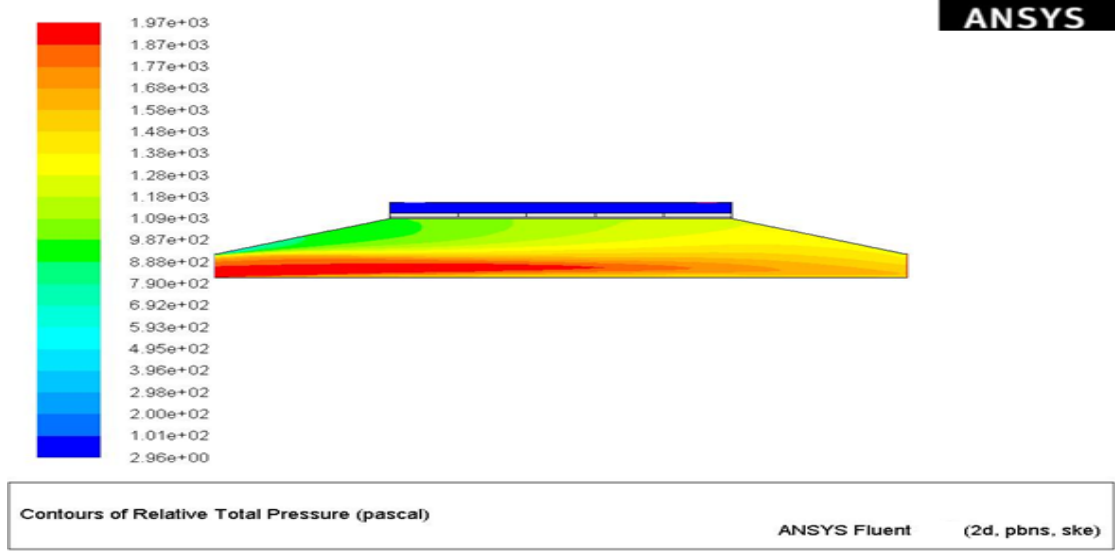
Şekil 3.54. Motorun 3500 dak -1 devrinde TEJ sisteminde oluşan toplam basınç dağılımı
