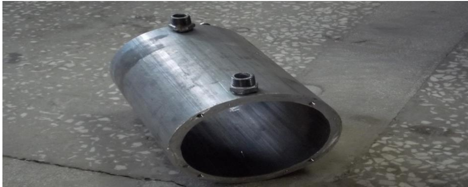
řekil 2.14. Al 6061 Silindir ceket
