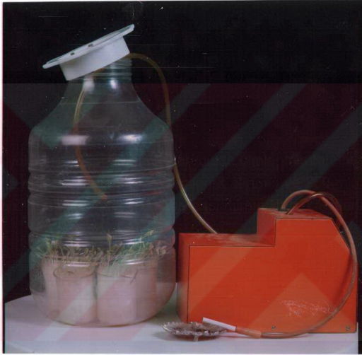
Şekil 2.2.1.1 : Bitkilerin yerleştirildikleri kapalı sistem (PET bidon ) ve bu kapalı sisteme sigara dumanı vermek için kullanılan vakum pompası.
