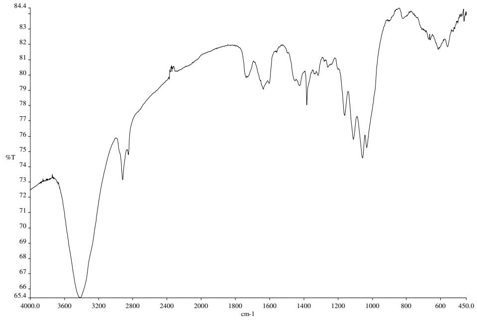
Ek 6. Selüloz- g -4VP aşı kopolimerinin IR spektrumu
