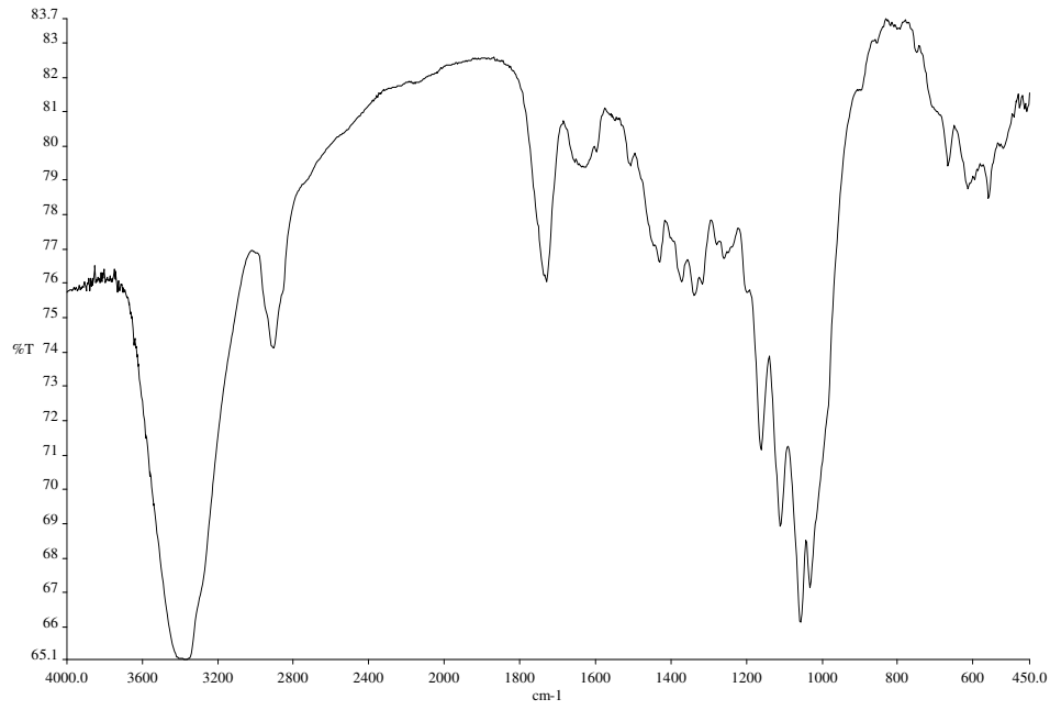
Ek 9. Selulöz-g-DAAM aşı kopolimerinin IR spektrumu
