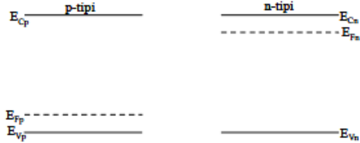
Şekil 3.2 pn eklem oluşmadan önceki p-tipi ve n -tipi yarıiletkenin enerji-band diyagramı [3].
