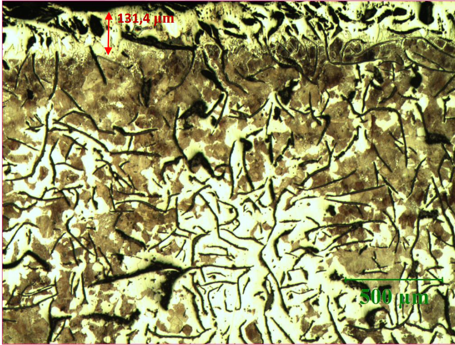
Şekil 6.61. Borlama işlemi sonucunda volanın optik görüntüsü (50x)
