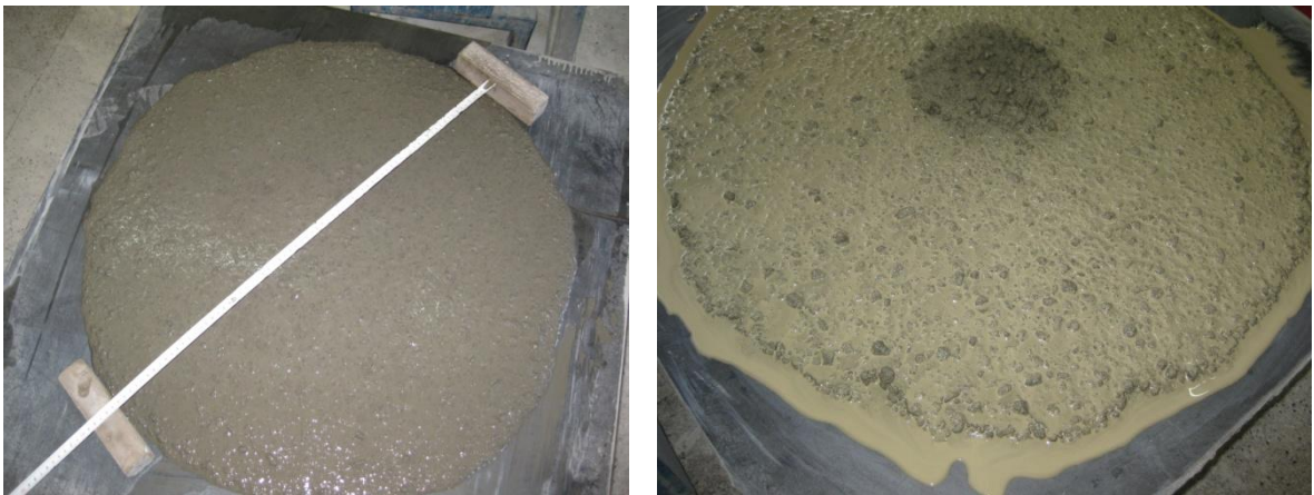
Şekil 5.2. Segregasyona uğramış ve segregasyona uğramamış taze beton
