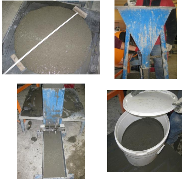
Şekil 4.1. Yayılma çapı, T 50 süresi, V hunisi, L kutusu, elek ayrışma direnci deneyi
