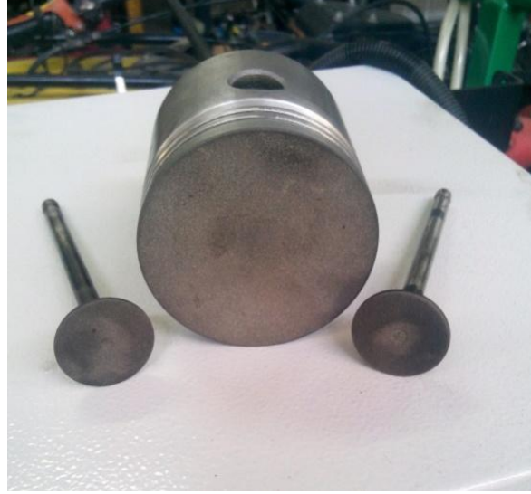
Şekil 6.11. Benzinli motorun kaplama yapılmış piston ve supaplarının görünümü
