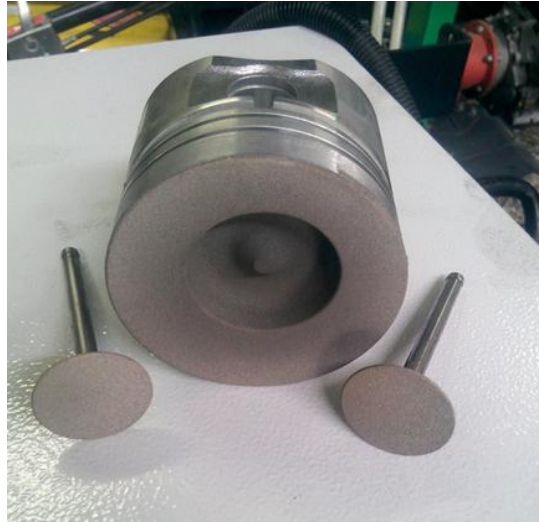
Şekil 6.10. Dizel motorun kaplama yapılan piston ve supaplarının görünümü
