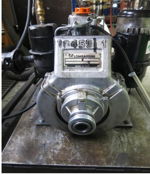
Şekil 6.1. 6LD 400 model Lombardini marka dizel motor
