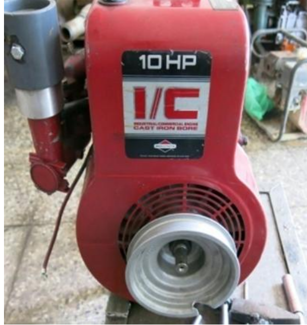
Şekil 6.2. Briggs&Stratton I/C Cast Iron 10 HP benzinli motor görüntüsü
