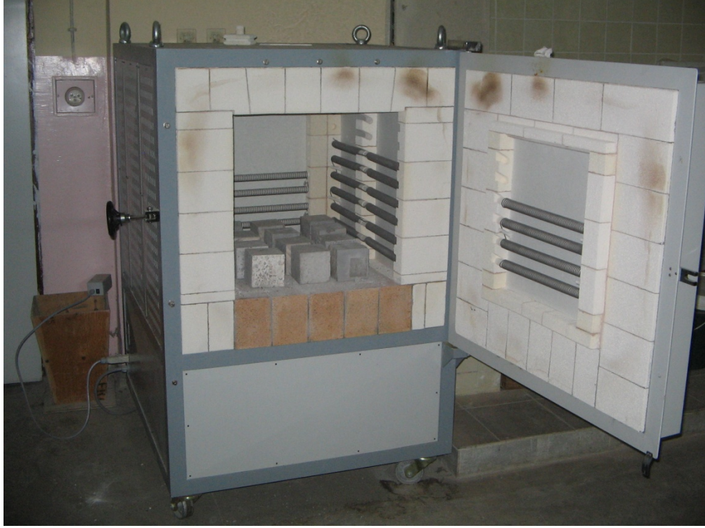
Şekil 4.9. Yüksek sıcaklık testlerinde kullanılan fırın
