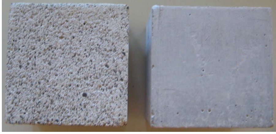
Şekil 5.34. Sülfürik asit çözeltisinde 45 gün bekletilmiş numune (solda) ve kontrol numunesi (sağda)
