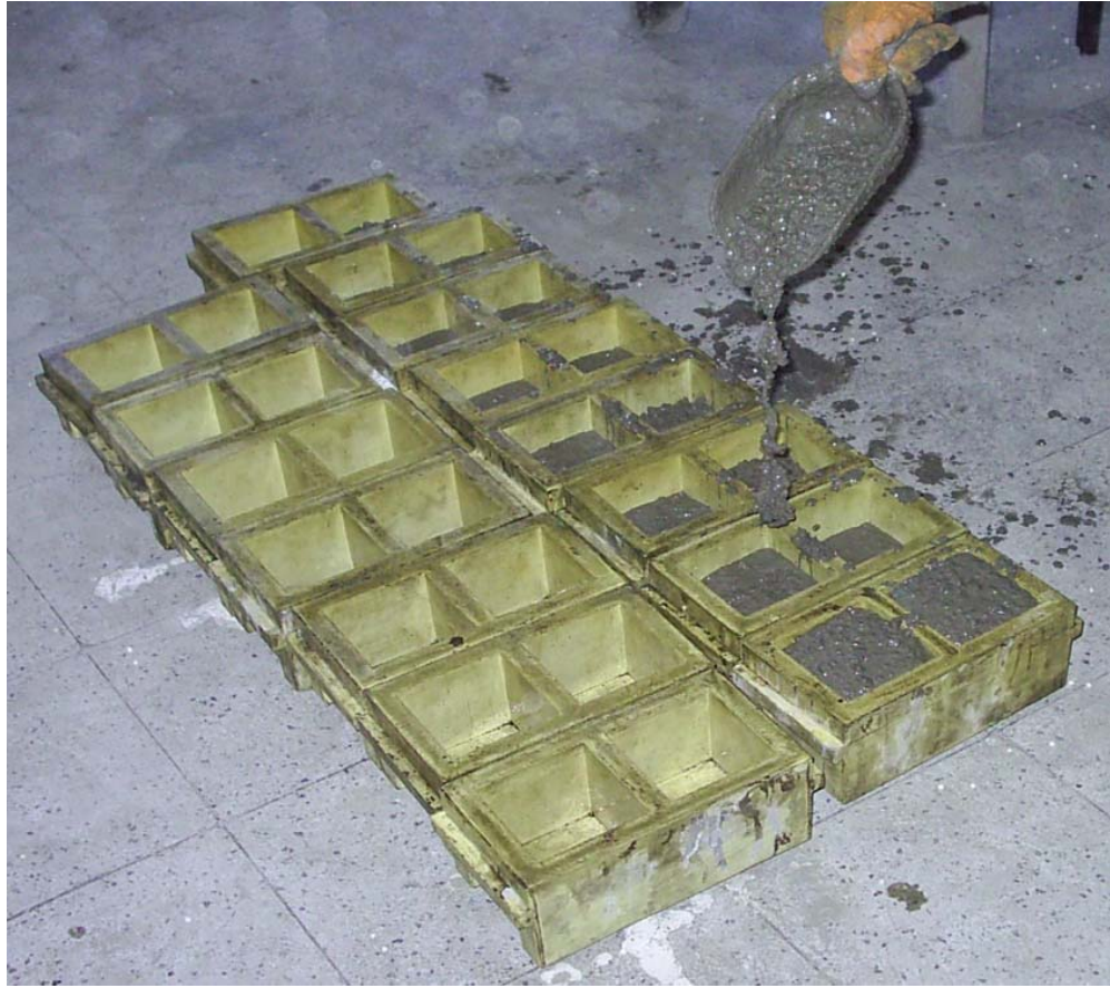
Şekil 4.2. KYHB'lerin kalıplara dökülmesi
