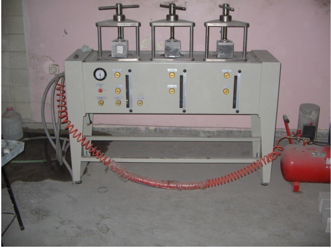
Şekil 4.10. Basınçlı su geçirimsizliği deneyi
