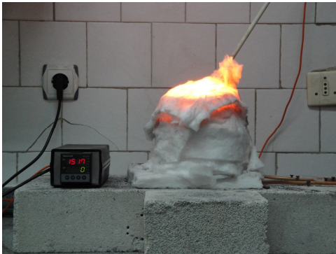
Şekil 5.1. Dökümde kullanılan indüksiyon fırını (RETERM-RTEF5 modeli)
