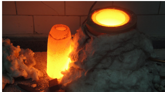
Şekil 5.1. Dökümde kullanılan indüksiyon fırını (RETERM-RTEF5 modeli)
