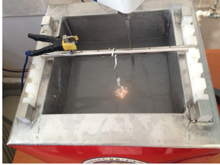
Şekil 31. Numune kaplama esnasındaki görüntüsü (Ti ilavesiz kaplama)
