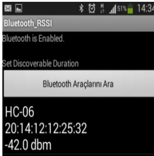
Şekil 4. 10. Mobil telefon ile RSSI ölçümü
