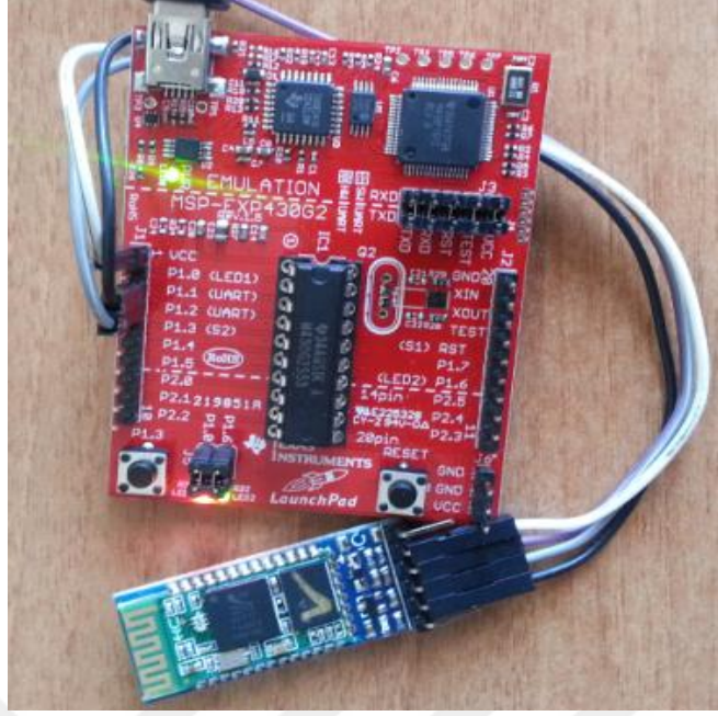
Şekil 4. 9. MSP430 kontrolör ve HC-06 bluetooth modül
