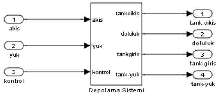
Şekil 6.7 Hidrojen depolama sisteminin modeli
