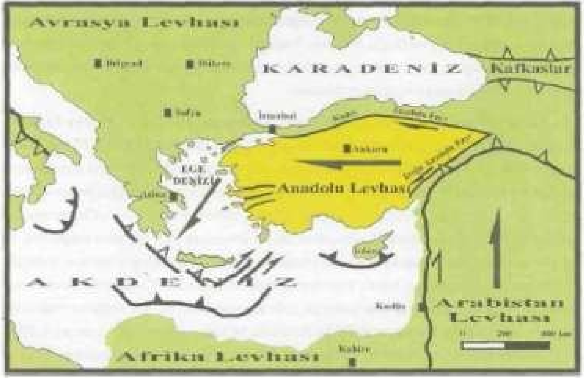
Şekil 2.2. Anadolu levhasının batıya kayma mekanizması (Okay vd, 1999)
