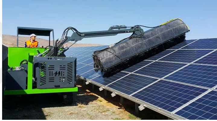
Şekil 3.23. Fotovoltaik panel temizleme
