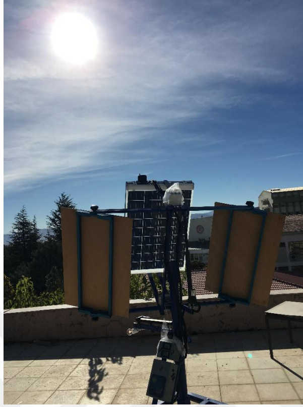
Şekil 5.23. Tek ayna etkin ve takip sistemi pasif (3.Durum: Sağdaki ayna paneli görmeyecek durumda)
