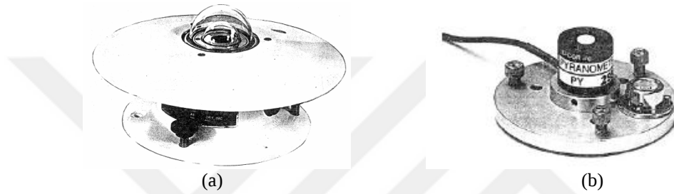
Şekil 2.13. Tipik piranometre örnekleri a. Termal dedektörlü b. Fotovoltaik dedektörlü [24]
