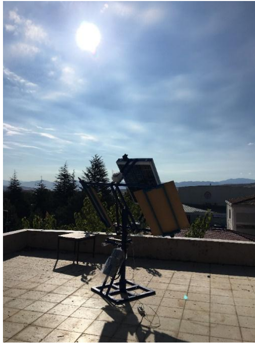
Şekil 5.12. İki ayna etkin ve güneş takip sistemi pasif (2.Durum)
