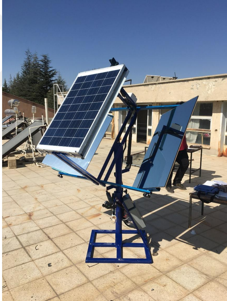
Şekil 5.1. İki ayna etkin ve güneş takip sistemi aktif (1.Durum)
