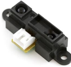
Şekil 5.18. GP2D120XJ00F analog mesafe algılayıcı[48]
