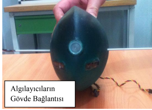
Şekil 5.17. Mesafe algılayıcılarının ön gövdeye bağlantısı
