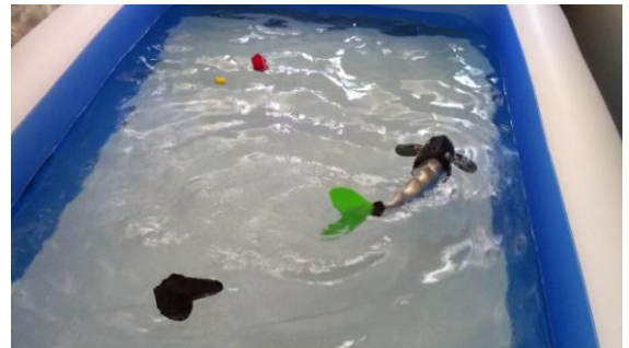
Şekil 6.15. Robot balığın dönerek yüzüşü
