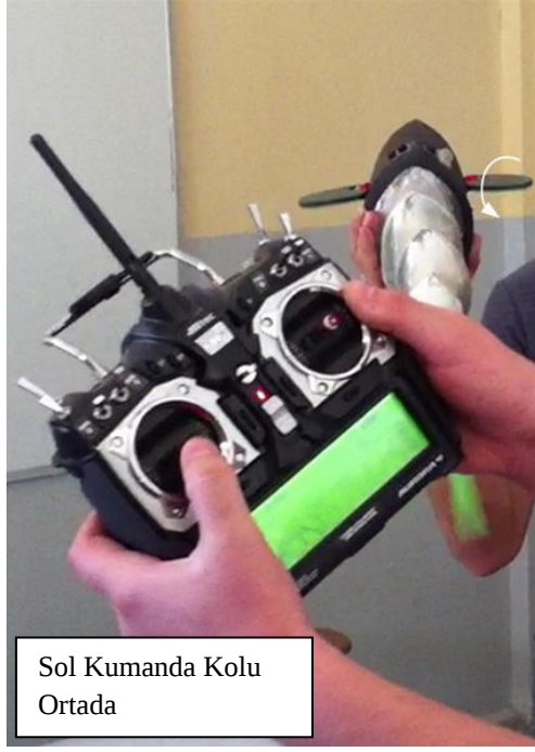
Şekil 6.21. Uzaktan kumanda ile göğüs yüzgeçlerinin kontrolü
