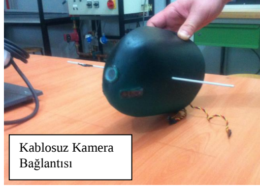
Şekil 5.16. HV-919 Kablosuz CCD Kameranın ön gövdeye bağlantısı
