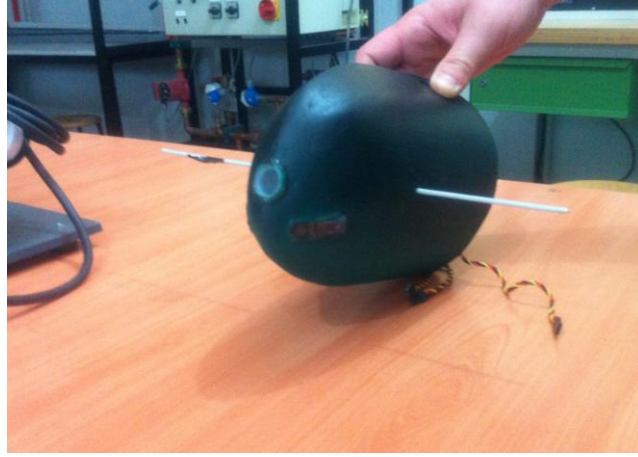
Şekil 5.8. Robot balığın ön gövde yapısı
