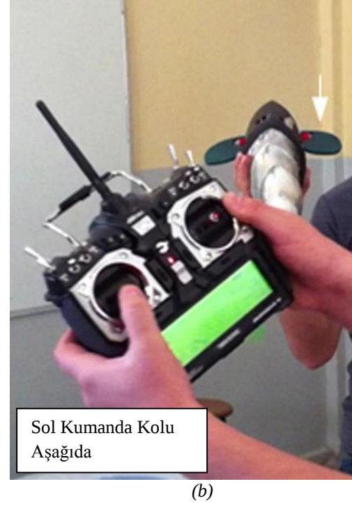
Şekil 6.21. Uzaktan kumanda ile göğüs yüzgeçlerinin kontrolü
