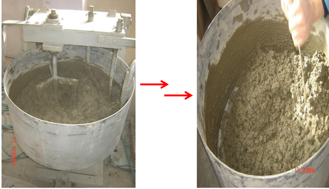
Şekil 3.16. Beton karıştırma mikseri
