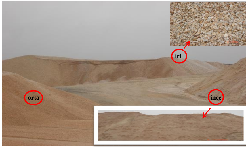
Şekil 3.4. Haroğlu kalker agregalarının görünüm
