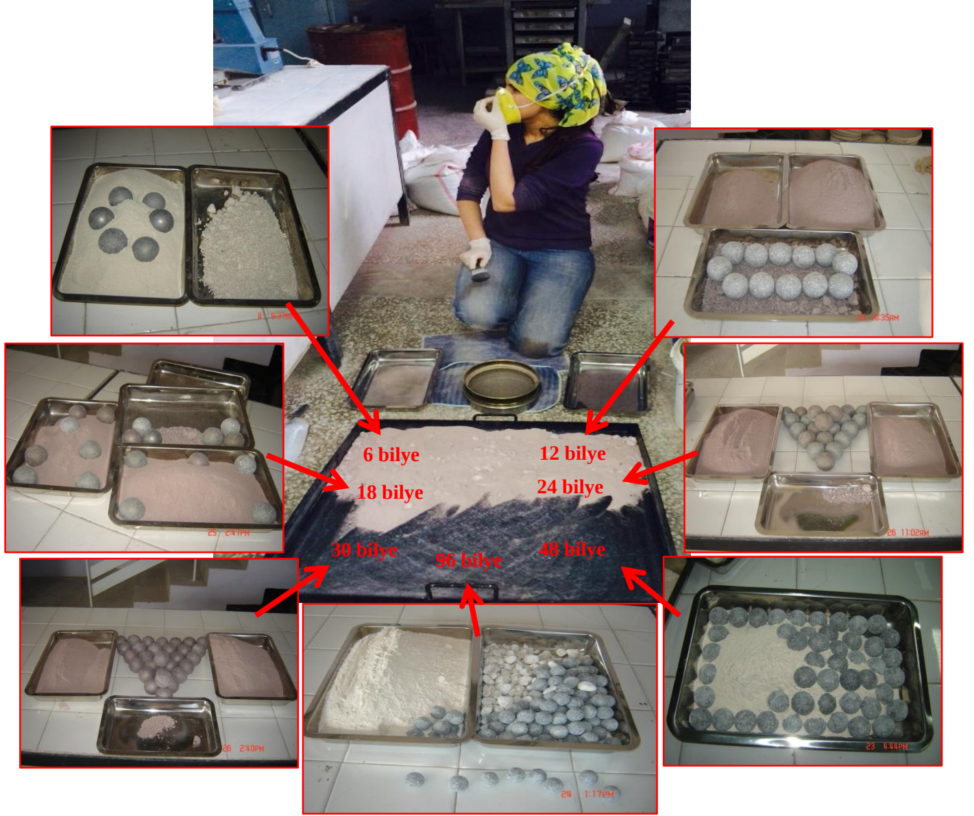
Şekil 3.14. 6, 12, 18, 24, 30, 48 ve 96 bilye ile Los Angeles
