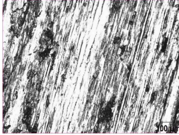
Şekil 5.12. S2 numunesinin aşınmış yüzeyinin 2500 m'lik alınan yol sonundaki optik mikroskop resmi, X 100
