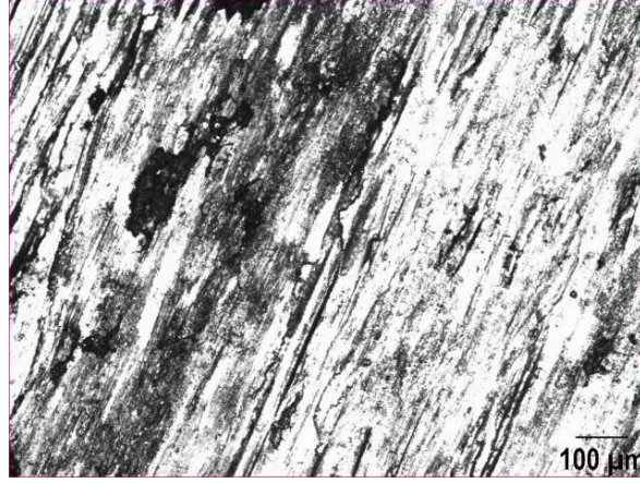
Şekil 5.8. SR numunesinin aşınmış yüzeyinin 2500 m’lik alınan yol sonundaki optik mikroskop resmi, X 100.
