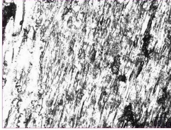
Şekil 5.20. S6 numunesinin aşınmış yüzeyinin 2500 m’lik alınan yol sonundaki optik mikroskop resmi, X 100
