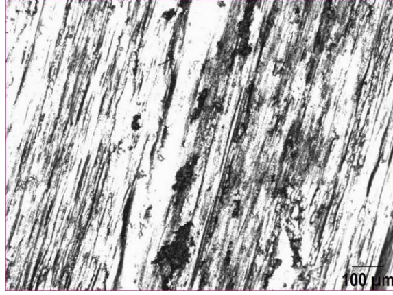
Şekil 5.18. S5 numunesinin aşınmış yüzeyinin 2500 m’lik alınan yol sonundaki optik mikroskop resmi, X 100
