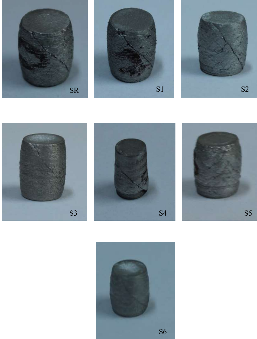
Şekil 5.24. Basma deneyi ile gevrek kırılma şeklinde plastik şekil değişimine uğramış numuneler
