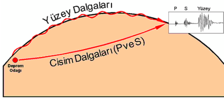
Şekil 3.5 Sismik dalgaların yeraltında ilerleme görüntüsü(Ortan,2015)
