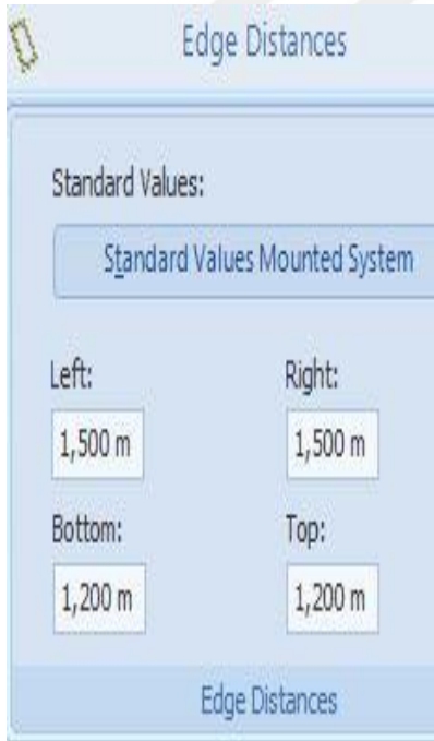
Şekil 4.17. PV-SOL saha yerleşim kenar ölçüleri
