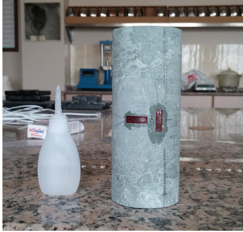
Şekil 5. 26. Deformasyon ölçerler yapıştırıldıktan sonra karottan bir görünüm
