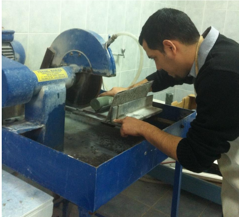
Şekil 5. 24. Karotların deneye hazır hale getirilmeden önceki kesilme işlemi yapılırken
