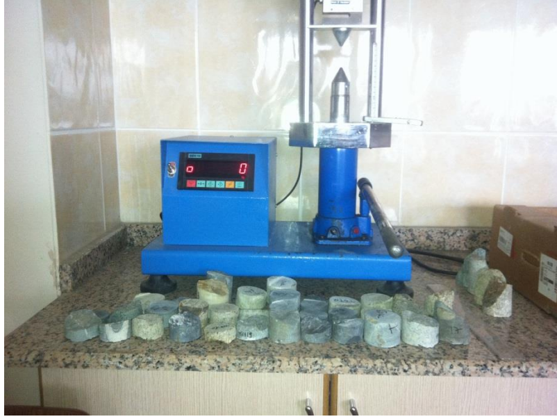
Şekil 5. 25. Nokta yük dayanımı belirlenmesinde kullanılan numuneler ve deney aleti
