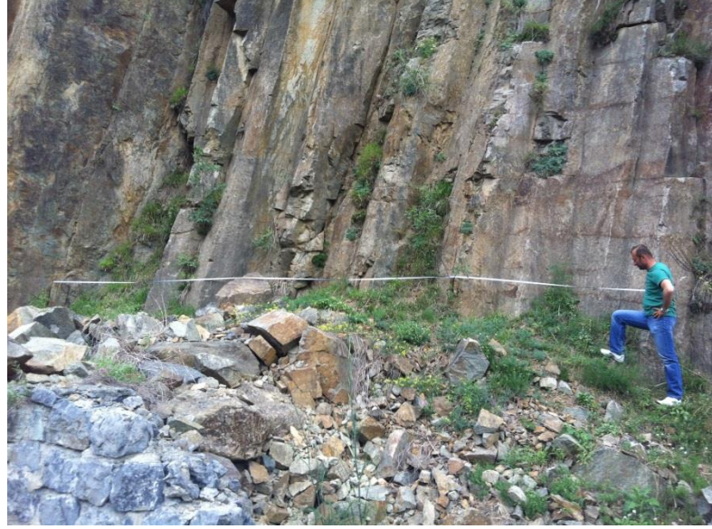
Şekil 5. 1. Kaçkar Riyodasiti üzerinde hat etüdü çalışması için belirlenmiş yatay hat
