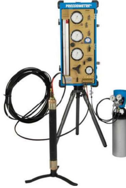
Şekil 5. 22. Menard GA tipi presiyometre deney aleti ve ekipmanı
