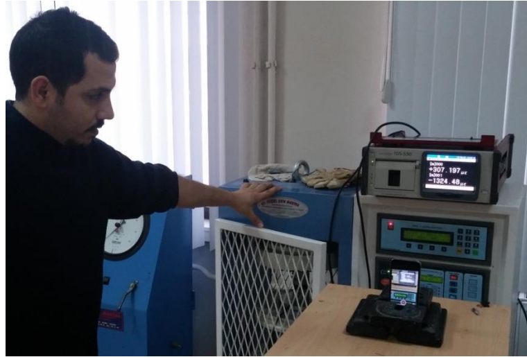
Şekil 5. 27. Elastisite modülü ve poisson oranı belirlenmesi
