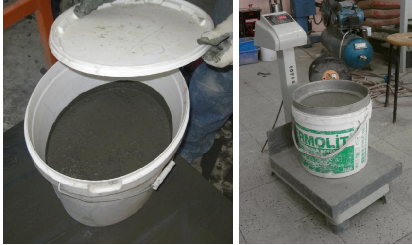
Şekil 5.7. Elek ayrışma testi için 15 dakika bekletilen taze beton
