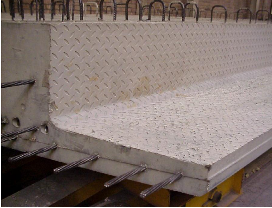
Şekil 2.3. KYB ile üretilen prefabrik elemanın yüzey detayı [12].
