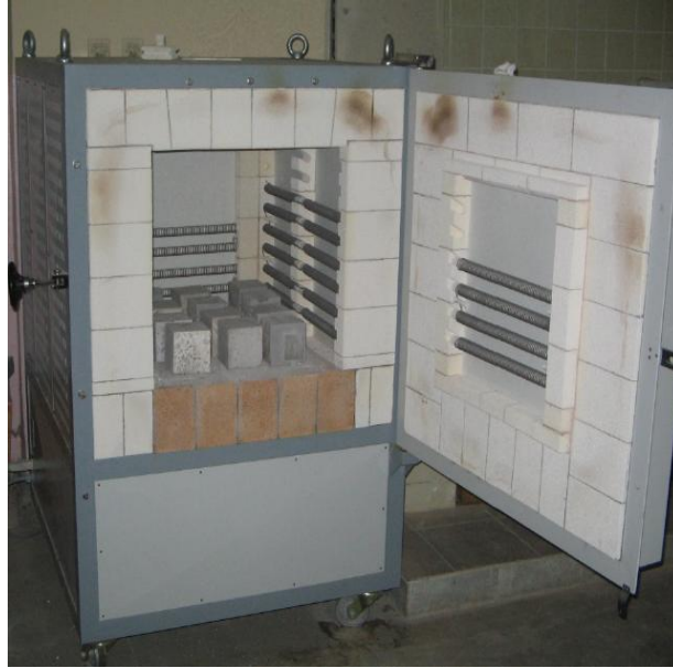
Şekil 5.16. Yüksek sıcaklık deneyleri için kullanılan fırın [10].
