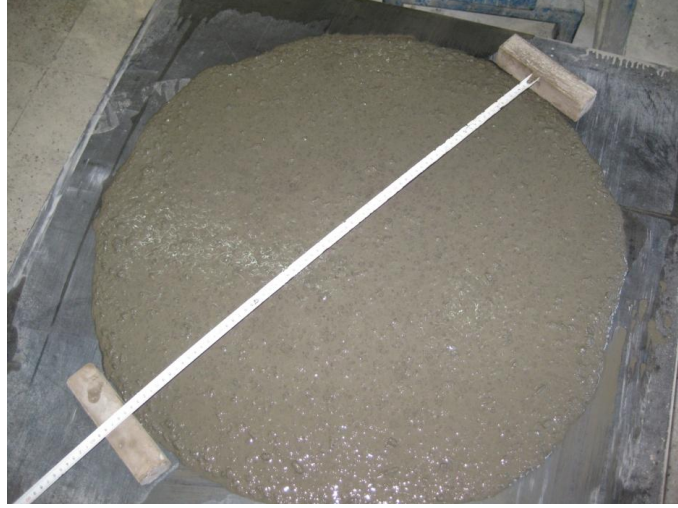
Şekil 5.4. Yayılması tamamlanan taze beton çapının ölçülmesi
