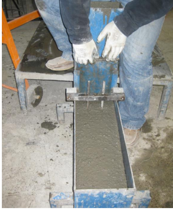
Şekil 5.6. L kutusunda demirler arasından taze betonun geçişi
