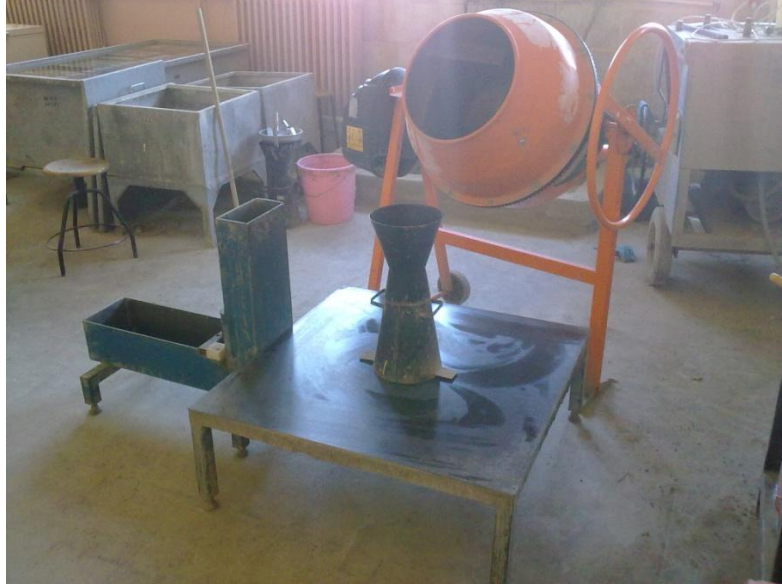
Şekil 5.2. 100 dm 3 kapasiteli karıştırıcı ve deney aletleri
