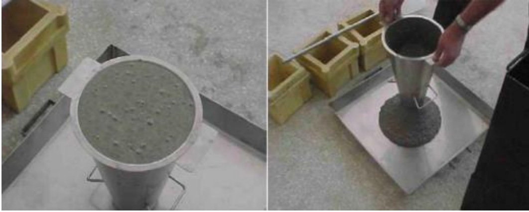
Şekil 4.4. Ters slump deneyinin yapılışı
