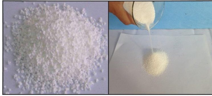
Şekil 3.4. SBS'in granül ve toz hali
