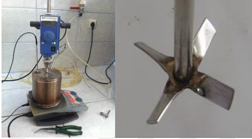
Şekil 5.1. Modifiye bitüm mikseri ve karıştırma başlığı
