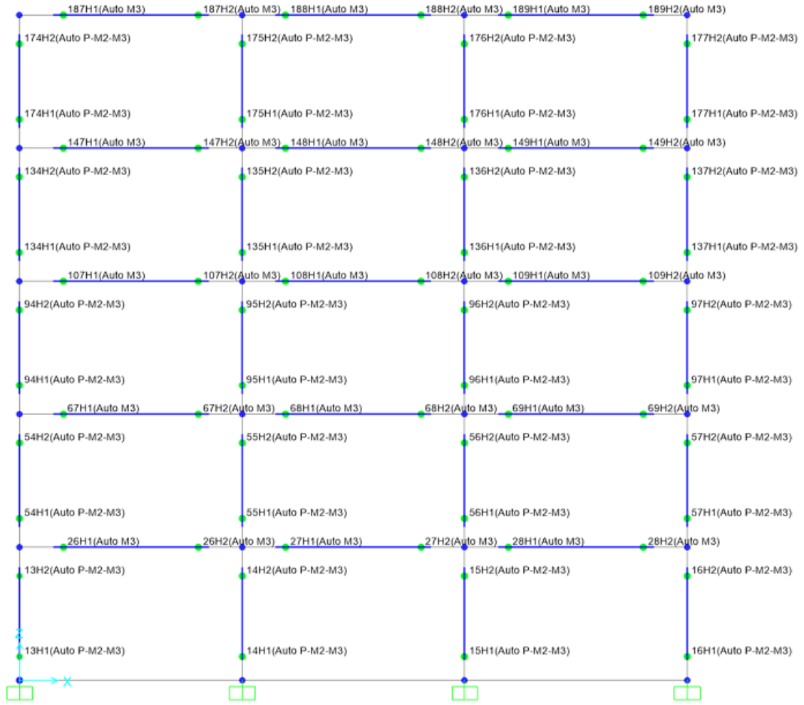
Şekil 5.8 SAP2000 programında tanımlanan kolon ve kiriş mafsalları
