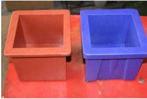
Şekil 2.1. Plastik küp beton kalıbı
