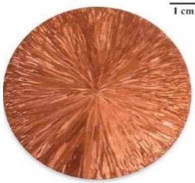
Şekil 2. 1. Merkezden dışarı doğru uzanan iğne şeklinde tanelerin görüldüğü silindirik bir bakır ingot kesiti (Azaklı, 2013)
