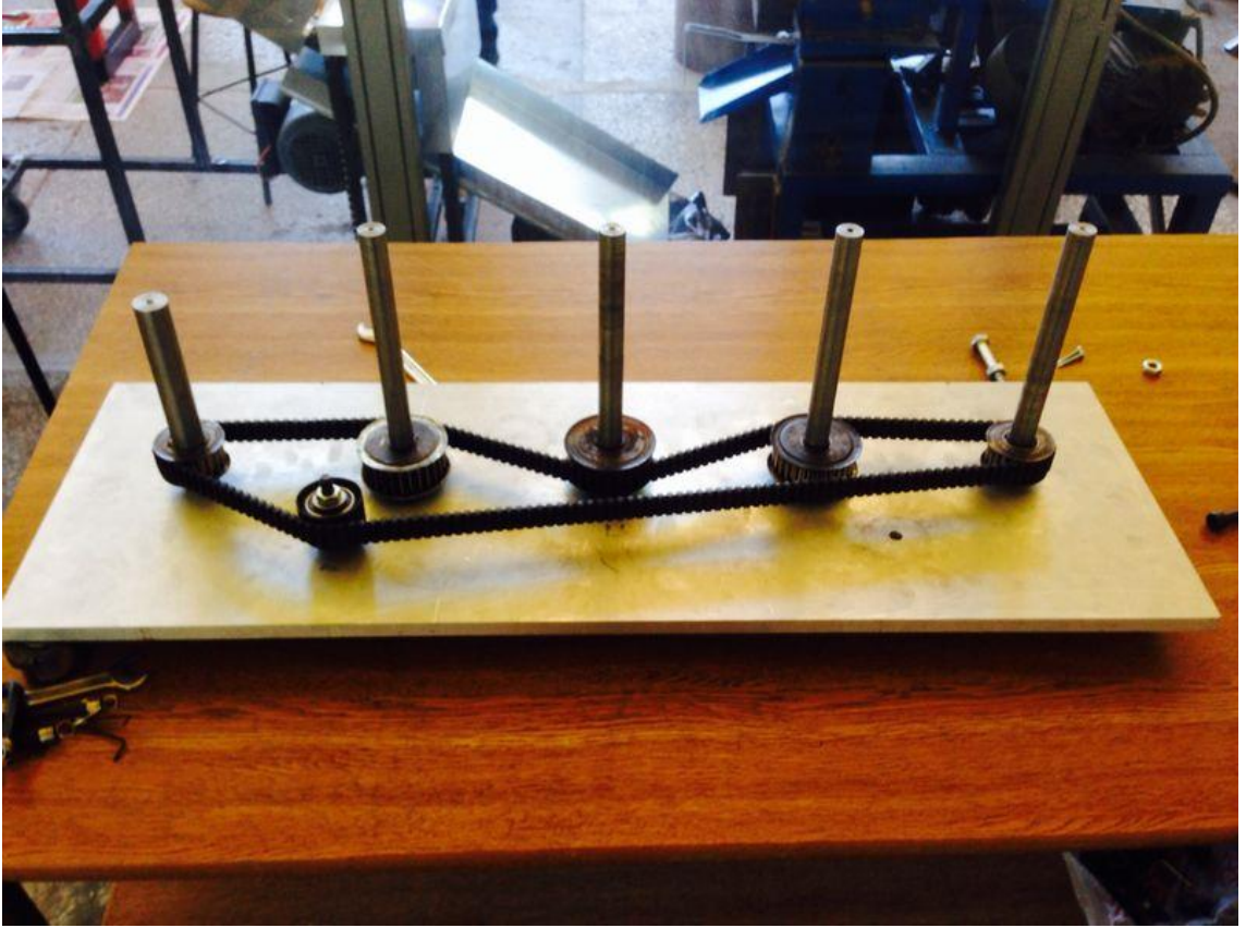
Şekil 3.23. Elektrik motoru tahrikli güç aktarma sisteminin montaj fotoğrafı
