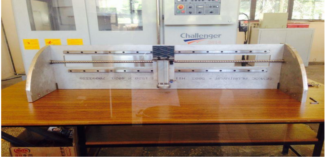
Şekil 3.26. Vidalı mil doğrusal (lineer) hareket elemanlarının, pnömatisik sistem ile birlikte montaj fotoğrafı
