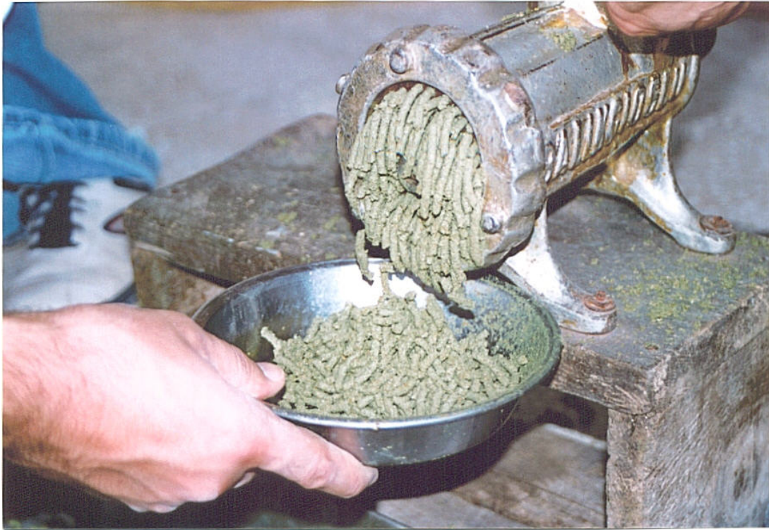
Şekil 3.3. Hamur haldeki yem materyalinin kıyma makinesinden geçirilerek pelet haline getirilmesi.
