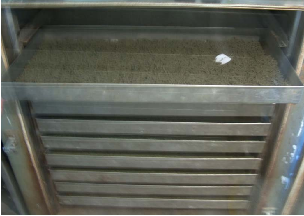
Şekil 3.4. Peletlenen yemlerin yem fırınında pişirilmesi.
