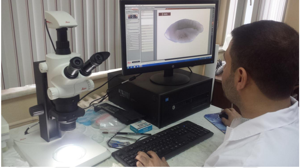
Şekil 2.5. Otolit yaşlarının Leica S8APO marka mikroskopta okunması
