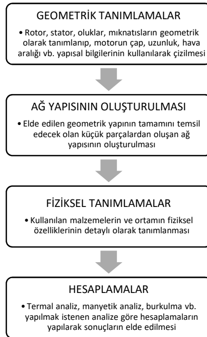
Şekil 3.12. SEY ile bir motorun modellenmesi ve analizinin aşamaları
