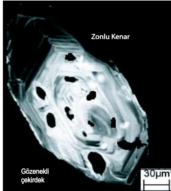
Şekil 5.21. CA2 nolu gözlü gnayslara ait zirkonlarda metamiktizasyon hasarı ve elek yapısı
