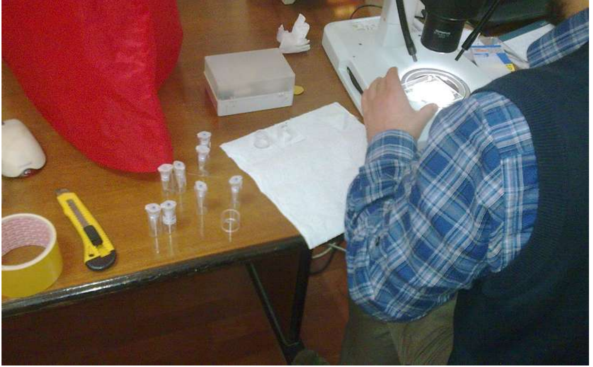
Şekil 2.11. Zirkon mineralinin mikroskopta ayıklanması
