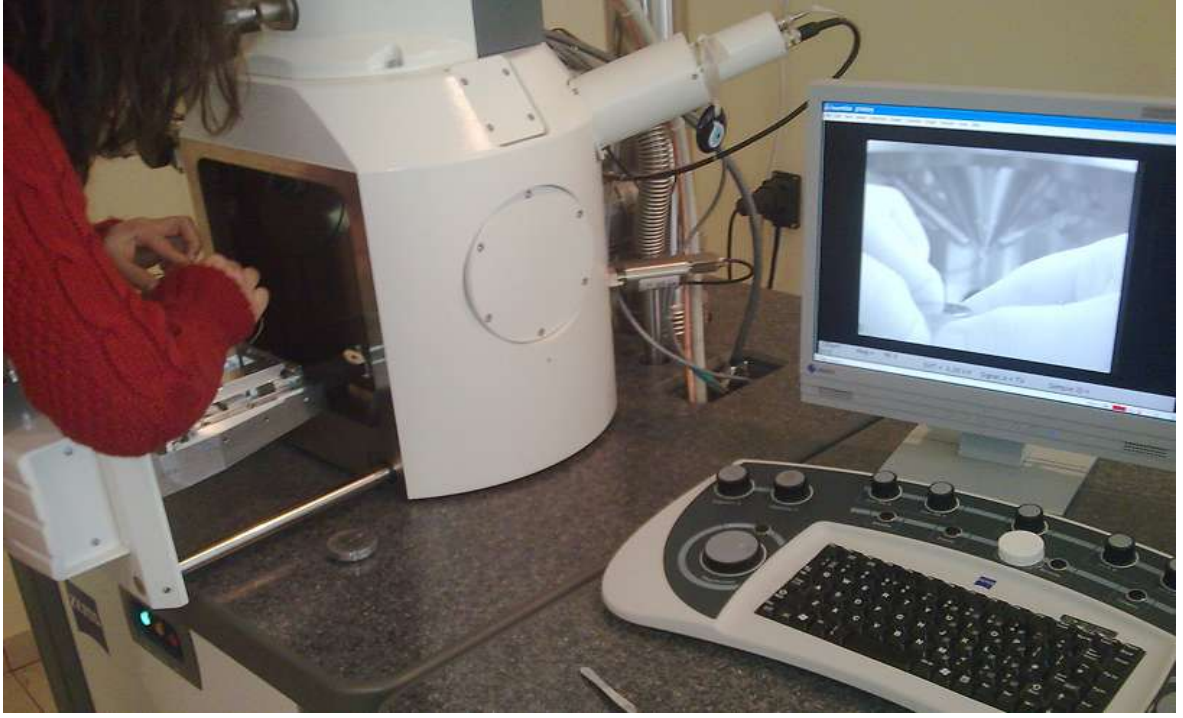
Şekil 2.17. Kathodölüminesans görüntülerinin elde edildiği makine (EVO 50)
