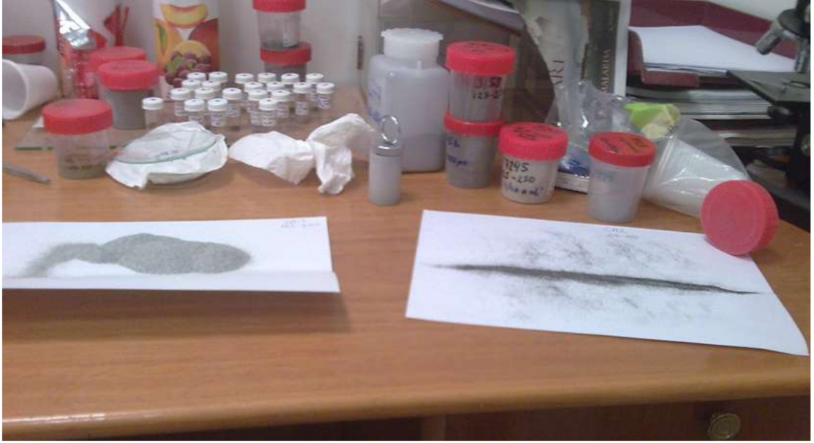
Şekil 2.7. Manyetik özelliğinden minerallerin ayıklanması
