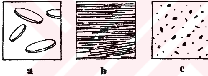
Şekil.3.6. Takviye malzemesinin şekline göre kompozitler [20] ( a-Plaka, b- Fiber, c- Parçacık )
