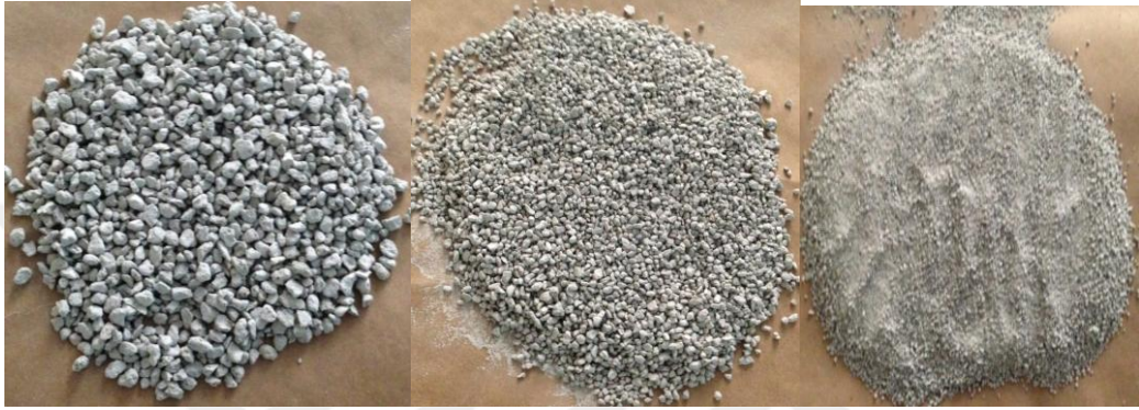
Şekil 2.5. 0-2, 2-4, 4-8 mm olarak boyutlandırılmış pomza agregaları
