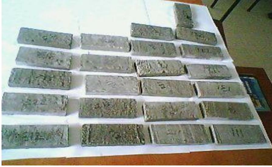
Şekil 6.4. Isıl iletkenlik katsayısının ölçülmesi için hazırlanan 0-2, 2-4, 4-8 mm tane boyutlu pomzalar ile 0.25 mm elekten geçirilmiş atık mermer tozu ve %0- %0.5- %1 kitreli deney numuneleri
