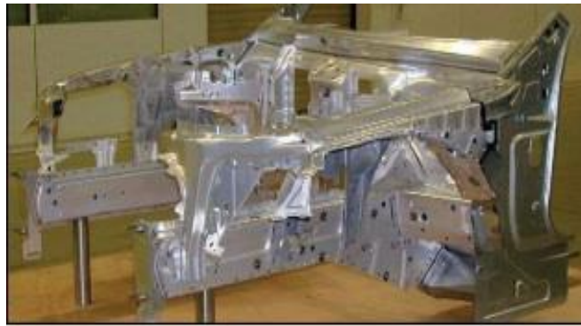
Şekil 2.2. AUDİ A3 levhadan üretilmiş ön bölümü [17].
