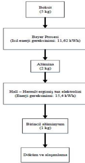
Şekil 2.5. Birincil alüminyum üretimi proses akım şeması [24].
