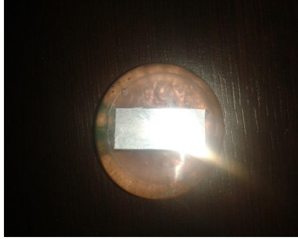
Şekil 4.3. Soğuk bakalitle kalıplanmış numuneler
