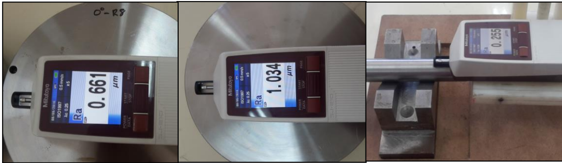
Şekil 5.5. Yüzey pürüzlülük ölçüm değerleri
