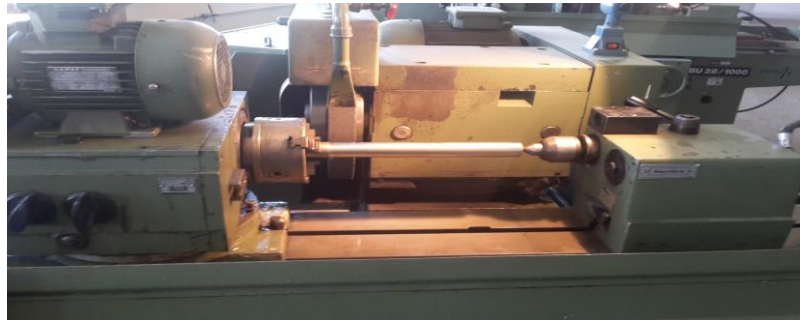
Şekil 5.3. Zimba taşlama işlemi
