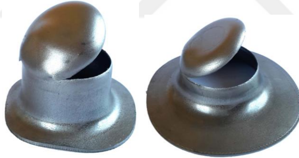
Şekil 6.21. Deneysel çalışmada elde edilen iş parçası hasarları
