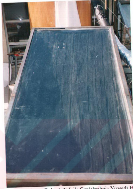
Resim 7.3 Delikli Bakır Plaka ve Bulaşık Teli ile Geniştirilmiş Yüzeyli Havahü Güneş Kolektörü
