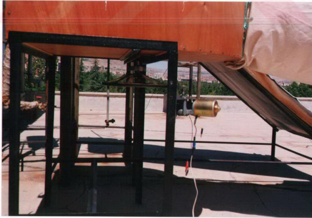
Resim 7.6 12 Voltluk Cam Silgi Motoru ile Dönme Mekanizması
