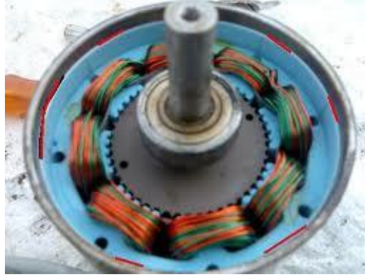
Şekil 4.3. Step motor iç görünümü
