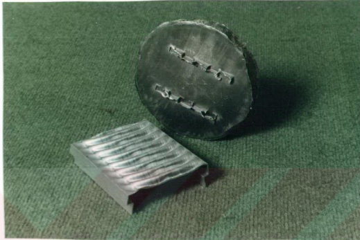
Şekil 5.4. İnce et kalınlıklı geniş yüzeyli profillerde sürtünmenin sebep olduğu katlanma hatası (malzeme AlMgSiOS, 400°C).
