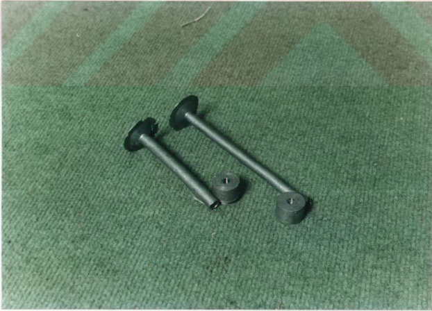
Kalın ve ince et kalınlığında çıkan boru ve blok örneği.
