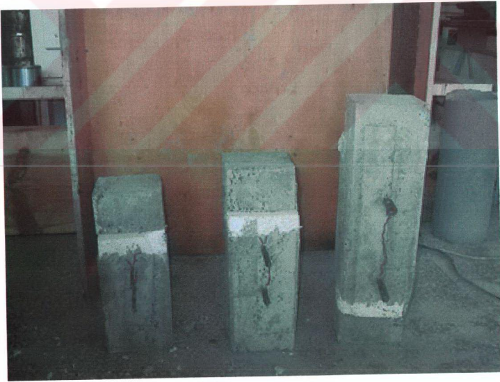
Şekil 4.5 Monolitik numunelerin ön ve yan yüzündeki kırılma detayları
