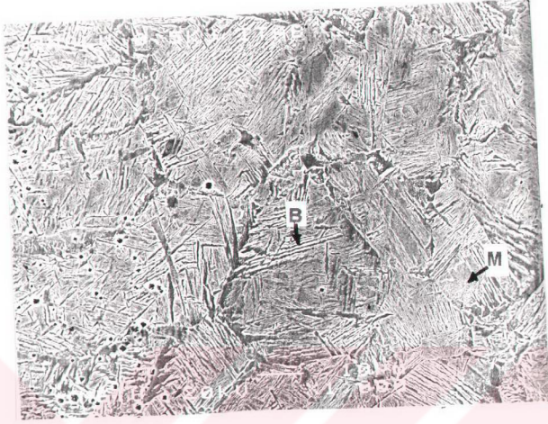
Resim 8. 0.5 kJ / mm enerji girişı için 2 nolu numunenin tane irileşen bölgesi (SEM).
