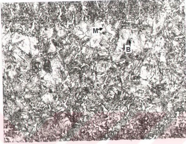
Resim 2. 0.5 kJ / mm enerji girişı için 1nolu numunenin tane irileşen bölgesi (X 200).
