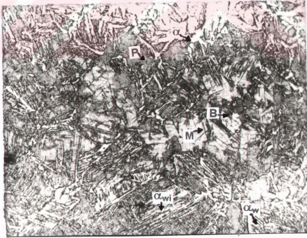
Resim 23. 1 kJ / mm enerji girişı için 3 nolu numunenin ITAB' ı (X 200).
