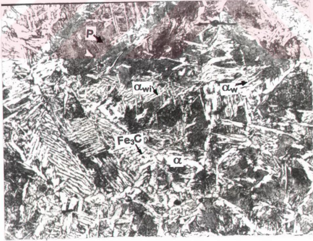
Resim 28. 1.8 kJ / mm enerji giriři için 1 nolu numunenin tane irileřen bölgesi (X 200).
