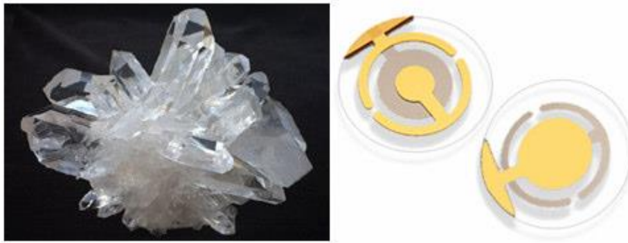
Şekil 2.3. Doğal kuartz kristal ve sensör uygulamalarında kullanılan kuartz kistaller [16].
