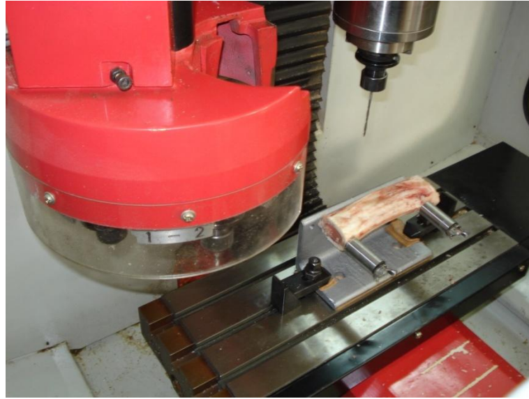
Şekil 3.3. Kemik numunenin bağlama aparatı ile tezgaha bağlanması
