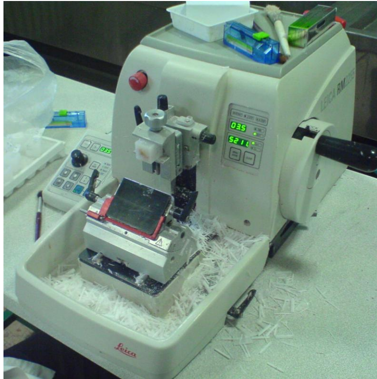
Şekil 3.18. Histopatoloji numunelerinden kesitler alan LEICA marka mikrotom cihazı
