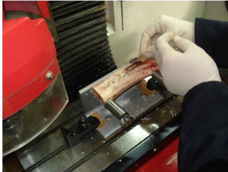
Şekil 3.14. Termokuplların önceden delinen deliklere yerleştirilmesi
