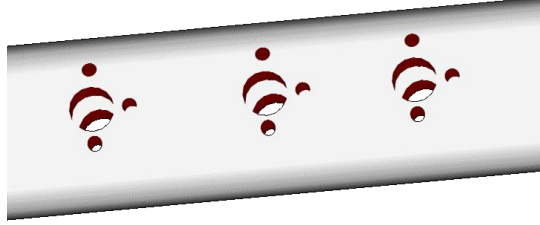
Şekil 3.13. Termokupl deliklerinin yerlerinin şematik gösterimi
