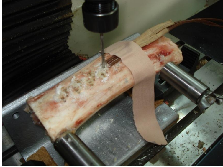
Şekil 3.15. Delme işlemi esnasında sıcaklık ölçümü
