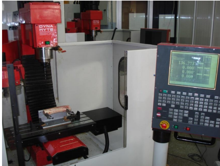
Şekil 3.6. Deneylerde kullanılan DYNAMYTE2900 CNC tezgahı
