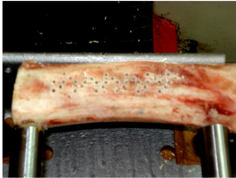
Şekil 3.4. CNC tezgahında hassas delinmiş delikler
