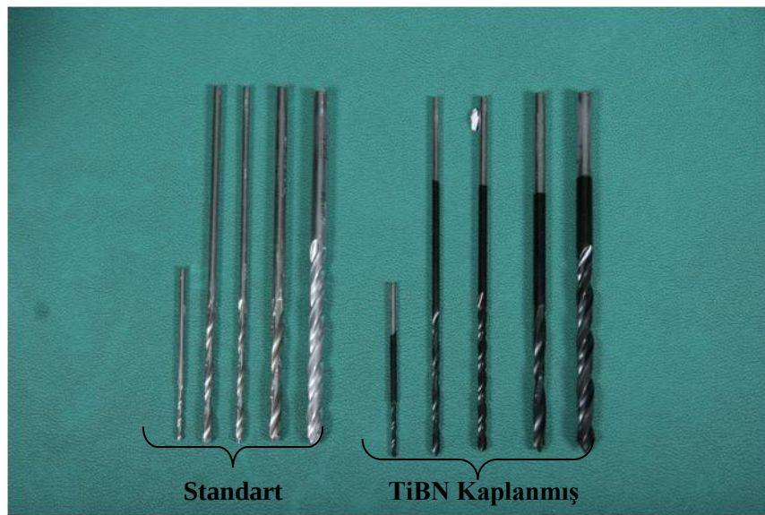
Şekil 3.9. Deneylerde kullanılan standart ve kaplanmış ortopedik matkap uçları
