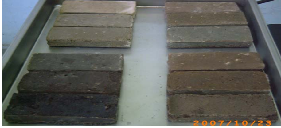
Şekil 5.9. %50 Epoksilenmiş bitkisel yağ (ESO, ESFO, EPO ve EZO), %70 uçucu kül, %30 kil ile hazırlanarak 160°C, 180°C ve 200°C’de işlem görmüş numunelere ait görüntüler
