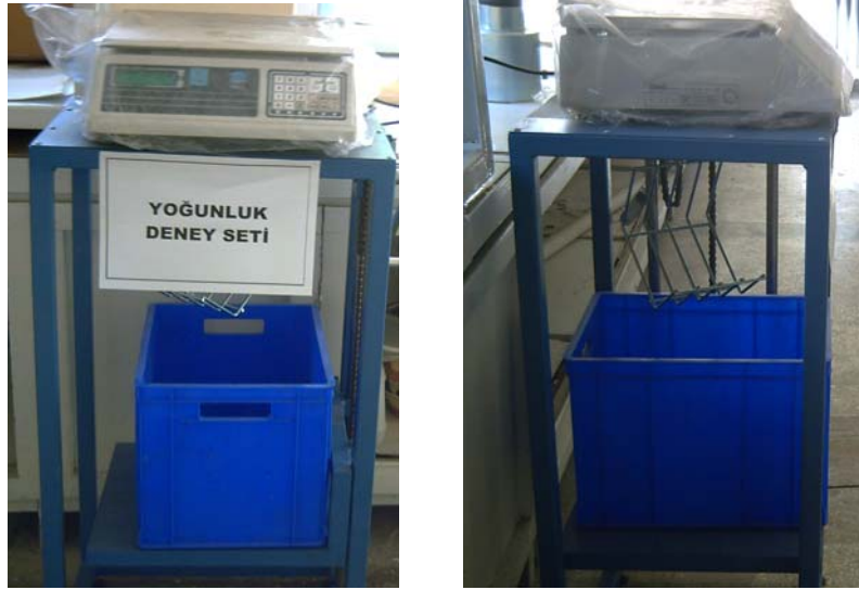
Şekil 5. 45. Kütle ve yoğunluk değerlerinin belirlendiği yoğunluk deney seti
