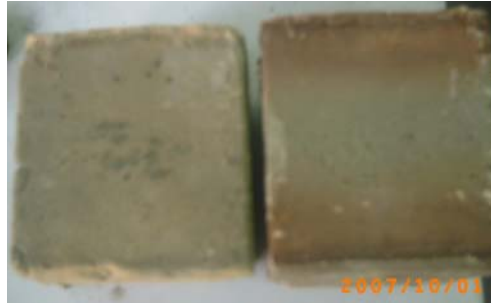
Şekil 5.4. %50 kil, %50 UK ve %50 ESO ile hazırlanmış numunenlerin etüvde 200 °C ve 220°C'de 10 saat bekletilmesi ile elde edilen malzemelerin görüntüsü
