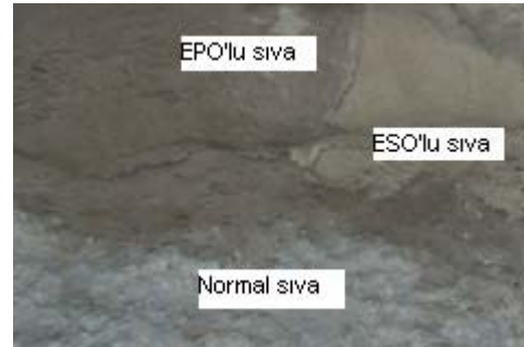
Şekil 5.44. Duvar yüzeyine sıvanmış harcların 14 ay sonraki görüntüleri
