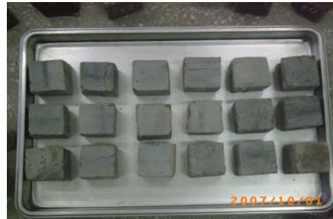
Şekil 5.36. Numunelerden bir kısmının aşınma işleminden önce ve sonraki durumu
