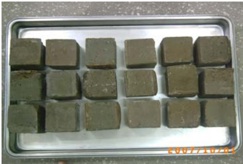
Şekil 5.36. Numunelerden bir kısmının aşınma işleminden önce ve sonraki durumu
