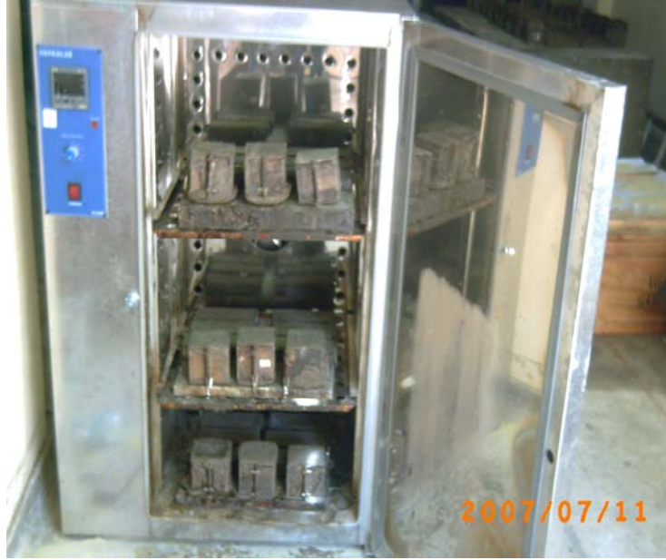
Şekil 5.10. Numunelerden bir kısmının etüvden çıkmadan önceki görüntüsü
