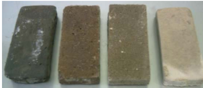
Şekil 5.6. Dört çeşit epoksilenmiş bitkisel yağla üretilmiş numunelerdeki renk farklılıkları (soldan sağa; EZO, EPO, ESFO, ESO)
