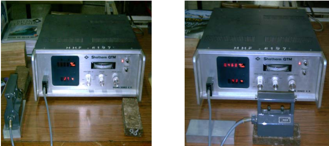
Şekil 5.11. Isı iletim katsayısı ölçme aleti
