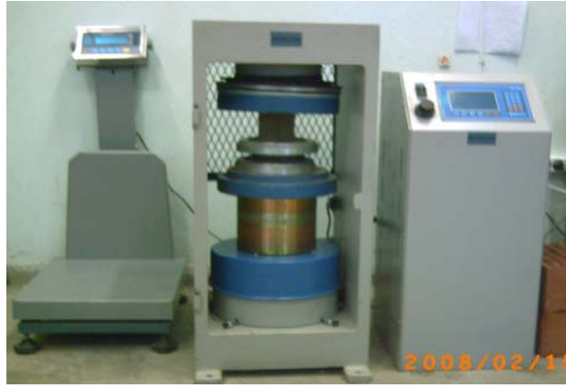
Şekil 5.25. Basma mukavemeti deneylerinin yapıldığı cihaz
