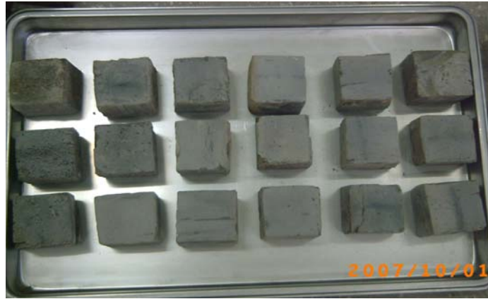
Şekil 5.41. Testereyle kesilip, aşınma kaybı testinden geçmiş numunelerin bir kısmı
