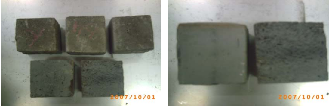
Şekil 4.5. Numunelerde aşınma sonrası izlenen gözenekli yapı
