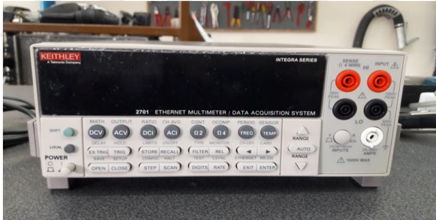
Şekil 2.6. Deneylerde kullanılan Keithley 2701 Ethernet Multimeter cihazının görüntüsü
