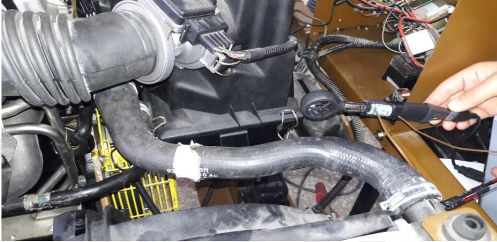
Şekil 2.13. DT 186 Anemometre cihazının uygulamadaki görüntüsü
