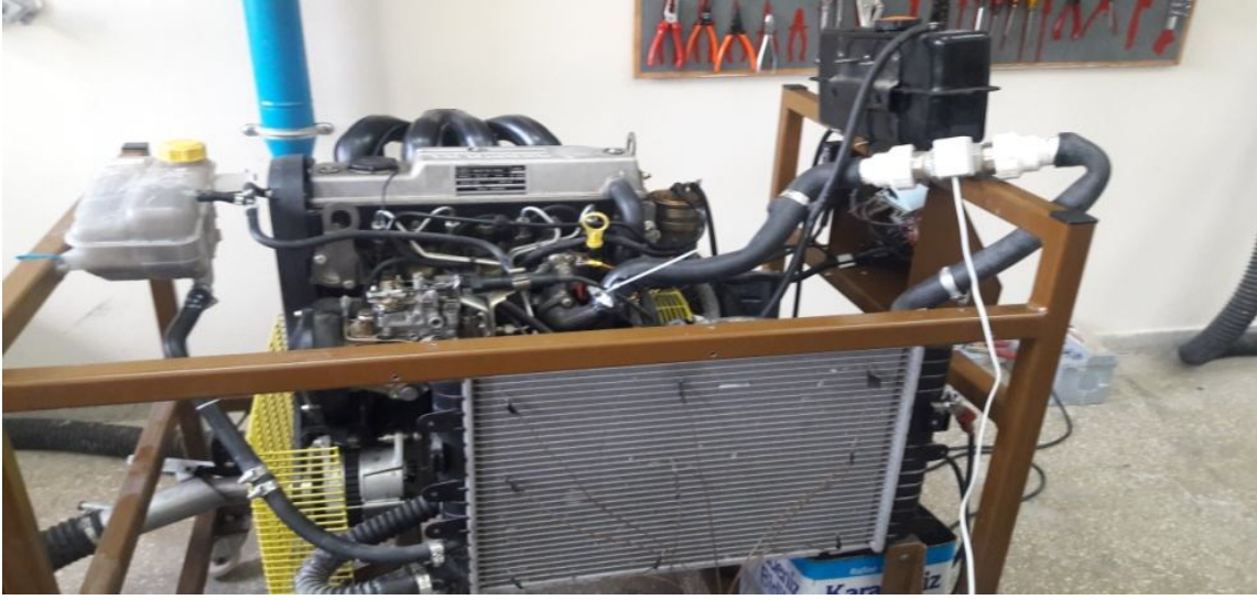
Şekil 2.9. Türbin debimetrenin dizel motora bağlantı yapılmış hali
