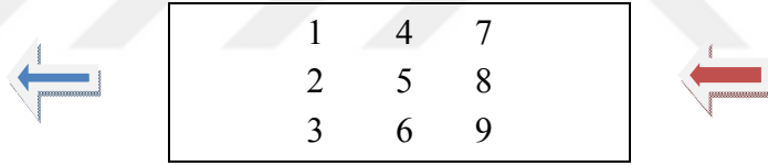
Şekil 2.4. Temsili olarak termokuplların radyatör üzerinde monte ediliş biçimi
