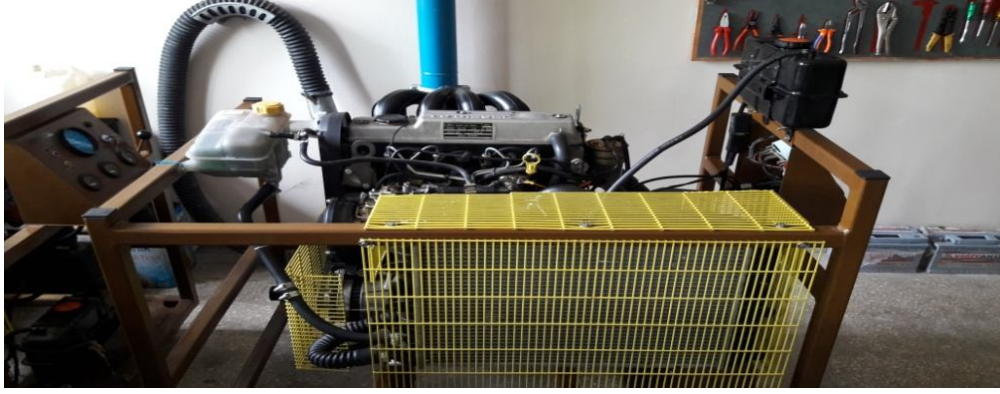
Şekil 2.3. Deney motoruna ait olan radyatör muhafaza ızgaraları
