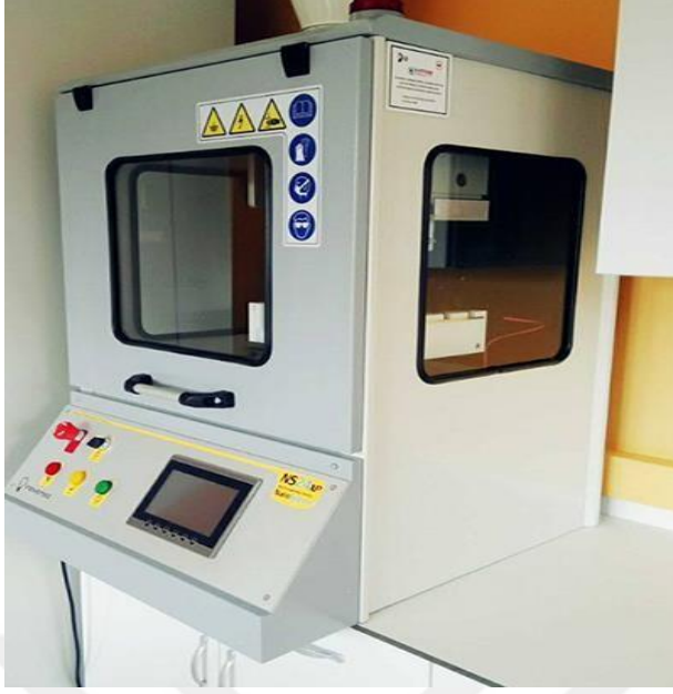
Şekil 4.3. Biyokompozit üretiminde kullanılan elektrospinning cihazı (Inovenso NS 24XP, Türkiye)
