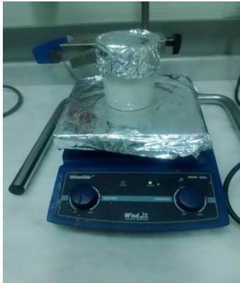
Şekil 4.1. Manyetik karıştırıcılı ısıtıcı metodu ile sentez işlemi
