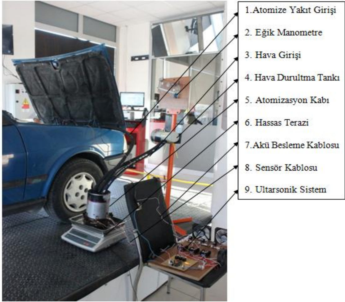
Şekil 2.26. Ultrasonik Atomizerin Deney motoruna Bağlanması
