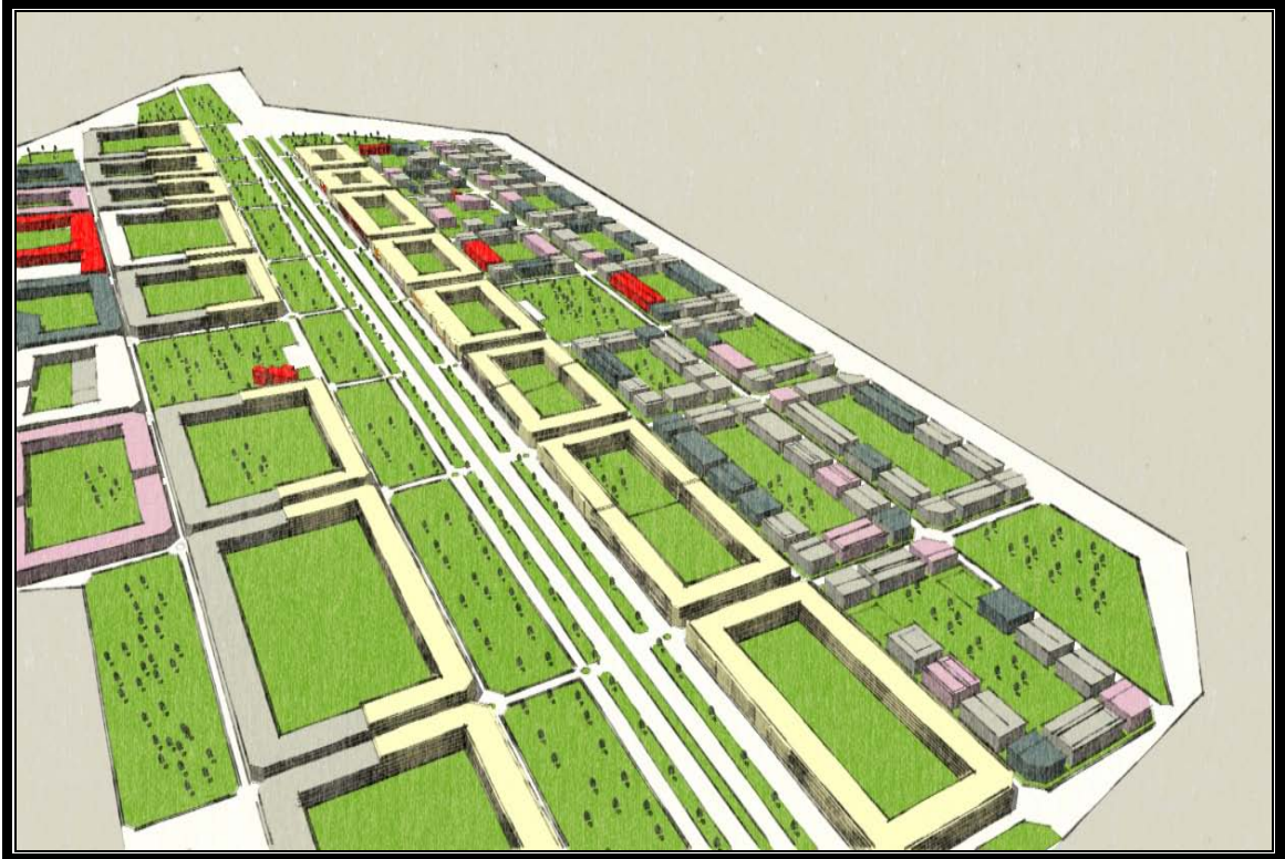
Şekil 13.- Yeni yerleşim alanı olarak önerilen askeri alanın mevzi imar planının AUTOCAD programına yardımıyla çizilen 3D sayısal arazi modellemesi örneğinin tamamlanmış hali.
