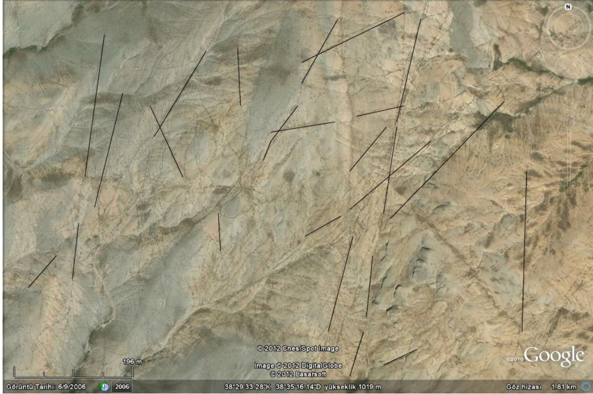
Foto 7: Elazığ Magmatitleri içerisinde gelişen kırık-çatlak sistemleri (Url:1)
