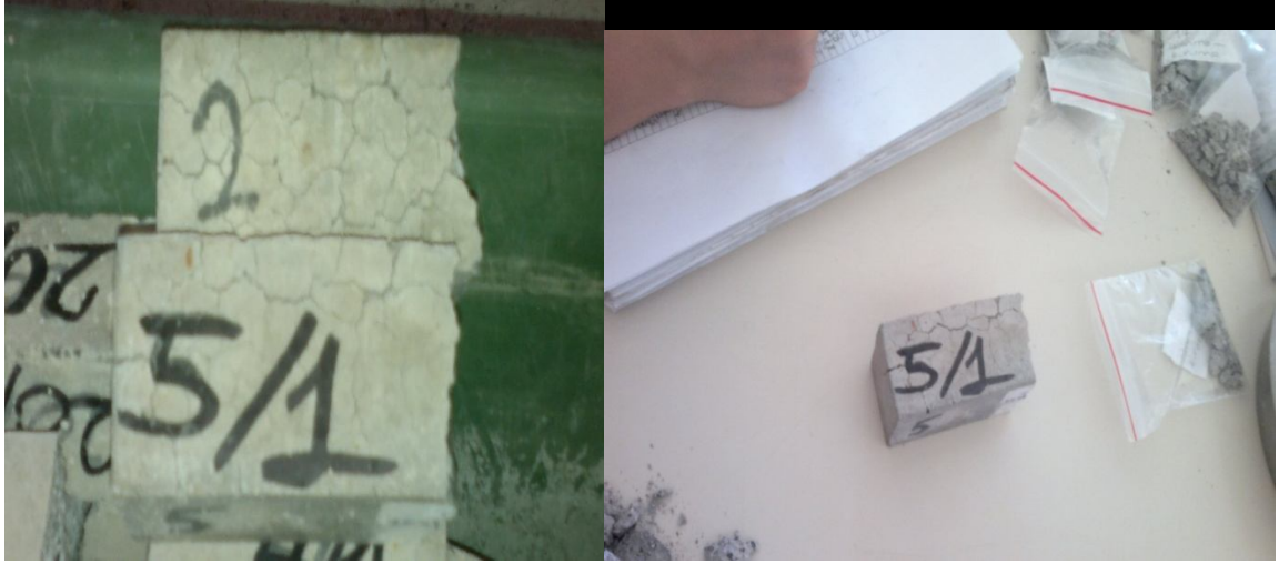
Şekil 3.29. Islanma-kuruma çevrimi sonrası zarar gören numuneler
