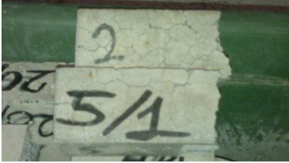
Şekil 3.14. Sülfatta ıslanma-kuruma sonrası numunelerin görünümü
