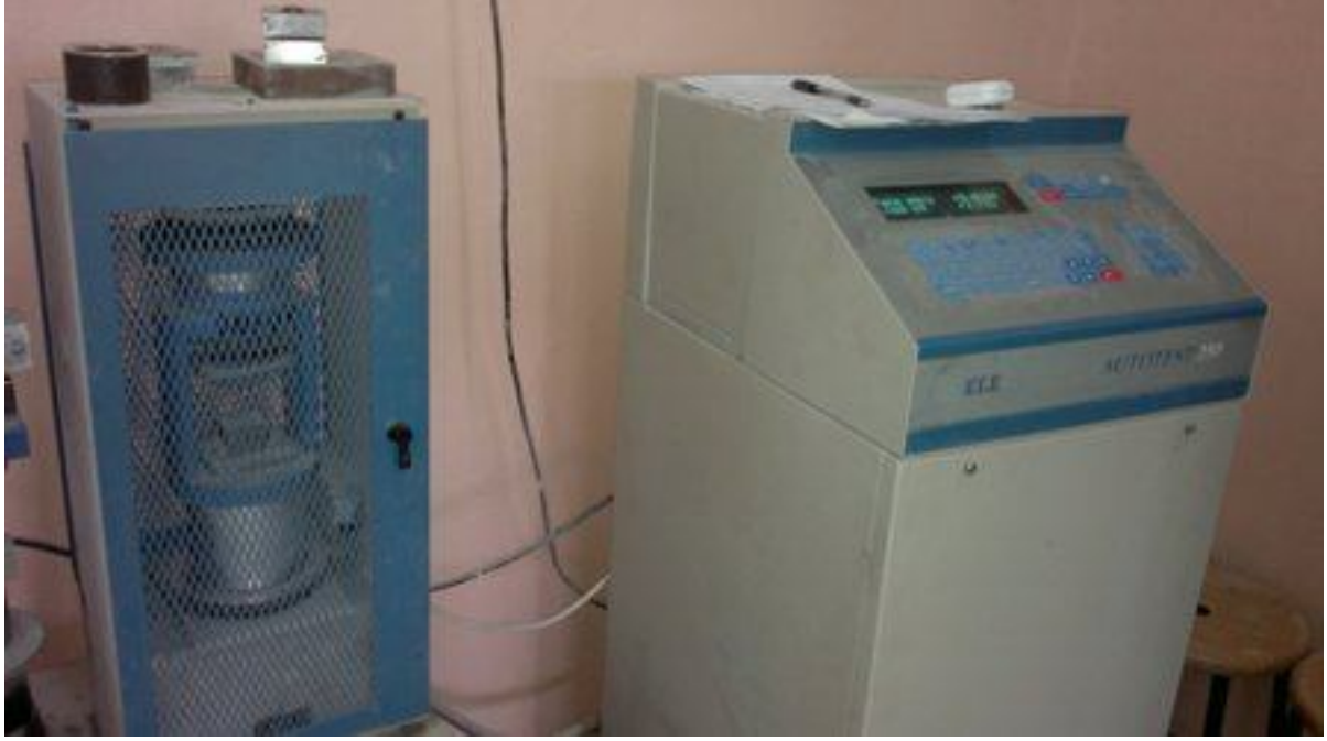
Şekil 2.7. Eğilme sonrası basınç deneyinin yapılması
