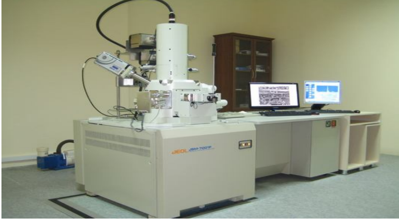
Şekil 2.11. Taramalı Elektron Mikroskobu (SEM) analiz ünitesi
