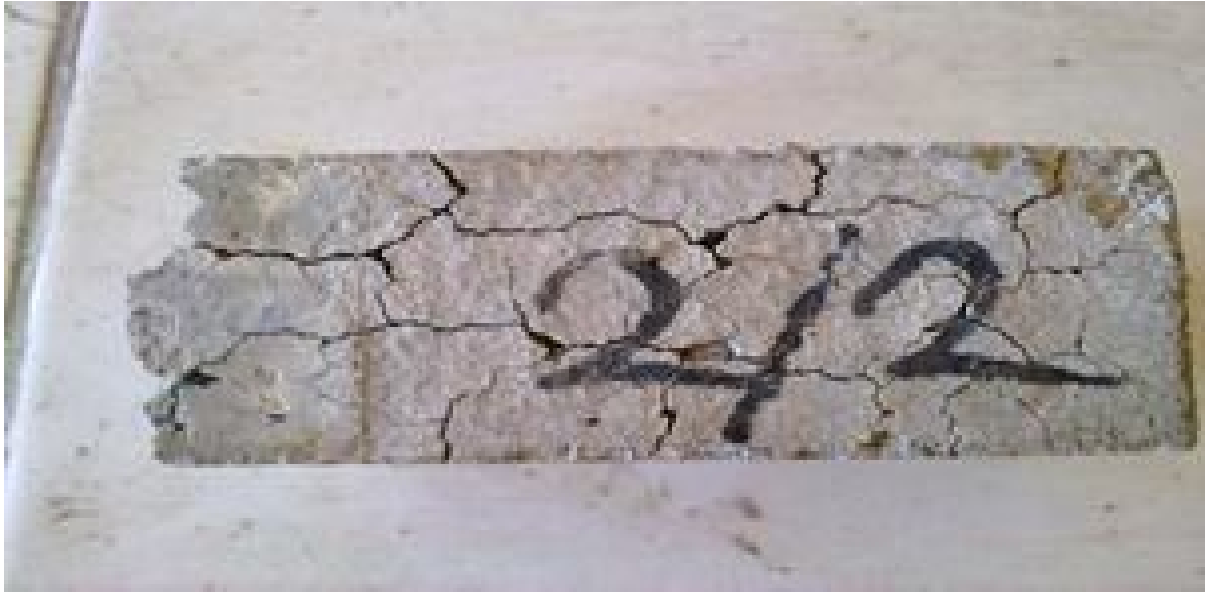
Şekil 3.30. Islanma-kuruma çevrimi sonrası genleşen numune
