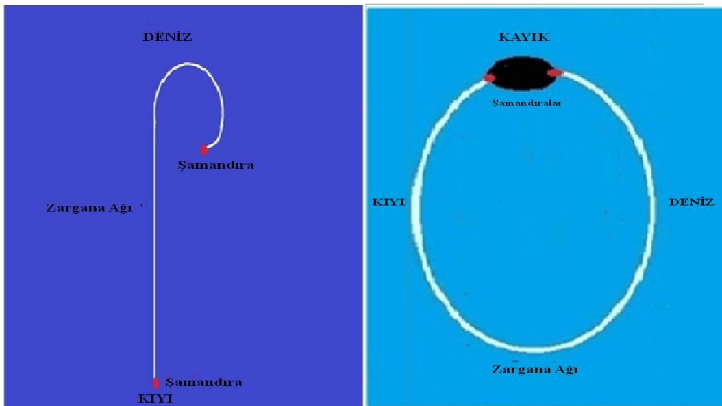
Şekil 19. Zargana ağının, salyangoz şeklinde kuruluşu ve gündüz çevirme avcılığı.
