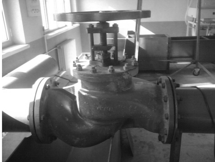
Şekil 3.5. Deney setinde giriş debisinin ayarlandığı debimetrenin ön kısmındaki vana
