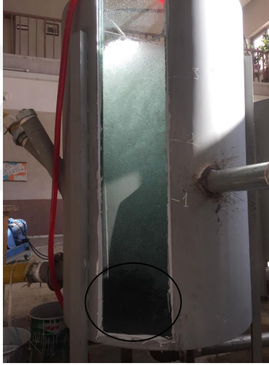
Şekil 3.1.1.1.h K=10\% konduit daralması, \alpha=45 derece saplanma açısı ve L=3 m konduit boyu ile kurulan deney düzeneğinin flotasyon kolonu içerisinde oluşturmuş olduğu hava kabarcığı oluşumu.
