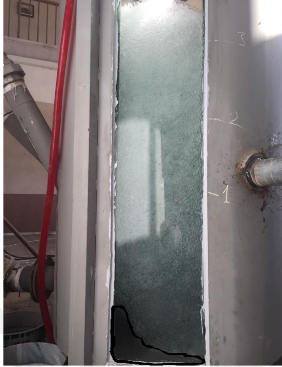
Şekil 3.1.2.1.c L=3 m konduit boyu, \alpha=60 derece saplanma açısı ve K=%10 konduit daralması ile kurulan deney düzeneğinin flotasyon kolonu içerisinde oluşturmuş olduğu hava kabarcığı oluşumu.
