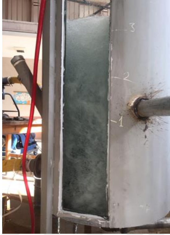
Şekil 3.1.1.1.a K=\%10 konduit daralması, \alpha=30 derece saplanma açısı ve L=1,5 m konduit boyu ile kurulan deney düzeneğinin flotasyon kolonu içerisinde oluşturmuş olduğu hava kabarcığı oluşumu.
