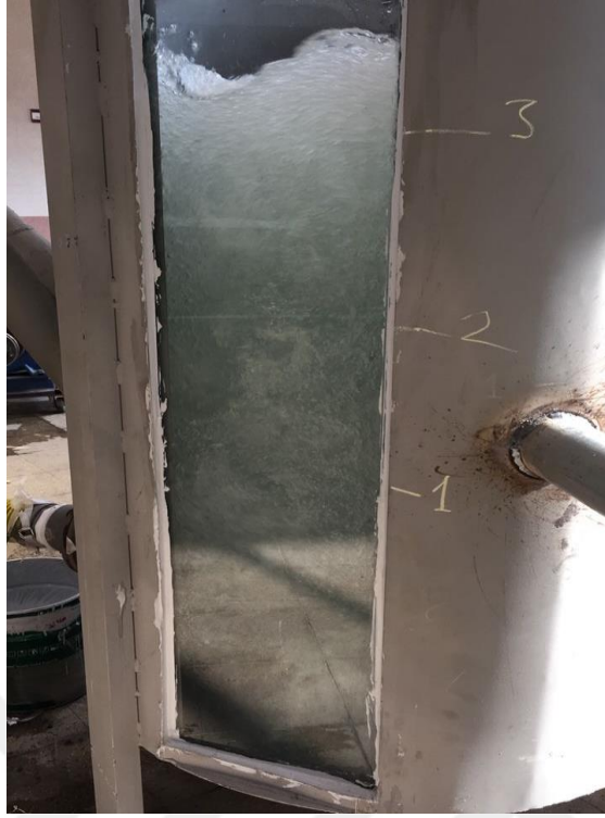
Şekil 3.1.2.1.e L=2 m konduit boyu, \alpha=45 derece saplanma açısı ve K=\%30 konduit daralması ile kurulan deney düzeneğinin flotasyon kolonu içerisinde oluşturmuş olduğu hava kabarcığı oluşumu.
