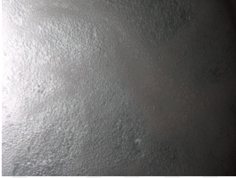
Şekil 3.1.1.1.c.a K=10\% konduit daralması, \alpha=60 derece saplanma açısı ve L=1,5 m konduit boyu ile kurulan deney düzeneğinin flotasyon kolonu içerisinde oluşturmuş olduğu hava kabarcığı oluşumunun üstten görünümü.
