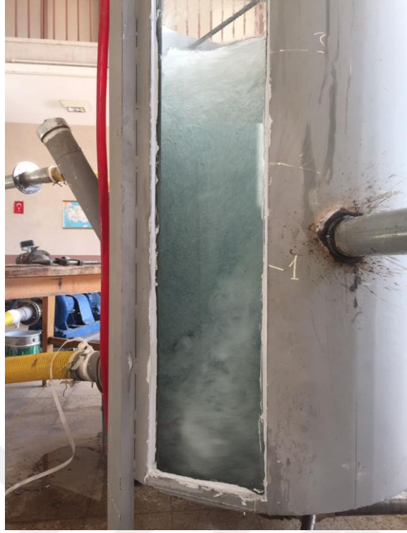
Şekil 3.1.2.1.d L=3 m konduit boyu, \alpha=30 derece saplanma açısı ve K=\%30 konduit daralması ile kurulan deney düzeneğinin flotasyon kolonu içerisinde oluşturmuş olduğu hava kabarcığı oluşumu.
