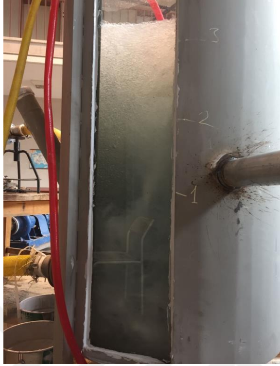
Şekil 3.1.2.1.g L=1,5 m konduit boyu, \alpha=30 derece saplanma açısı ve K=\%40 konduit daralması ile kurulan deney düzeneğinin flotasyon kolonu içerisinde oluşturmuş olduğu hava kabarcığı oluşumu.
