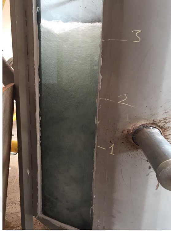
Şekil 3.1.1.1.f K=10\% konduit daralması, \alpha=60 derece saplanma açısı ve L=2 m konduit boyu ile kurulan deney düzeneğinin flotasyon kolonu içerisinde oluşturmuş olduğu hava kabarcığı oluşumu.
