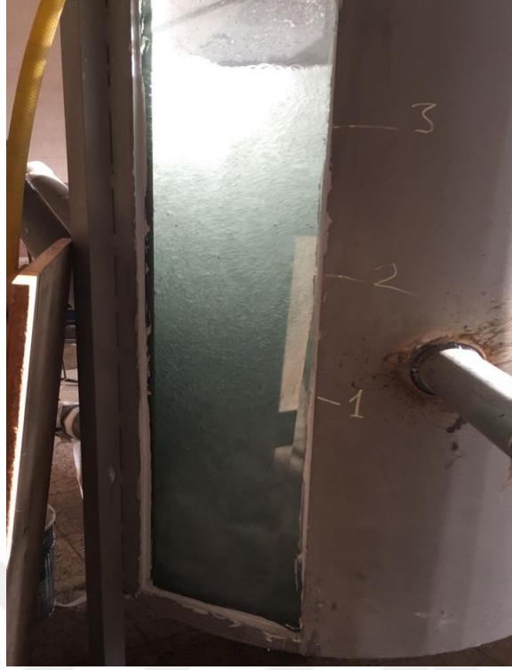
Şekil 3.1.2.1.f L=2 m konduit boyu, \alpha=60 derece saplanma açısı ve K=\%30 konduit daralması ile kurulan deney düzeneğinin flotasyon kolonu içerisinde oluşturmuş olduğu hava kabarcığı oluşumu.
