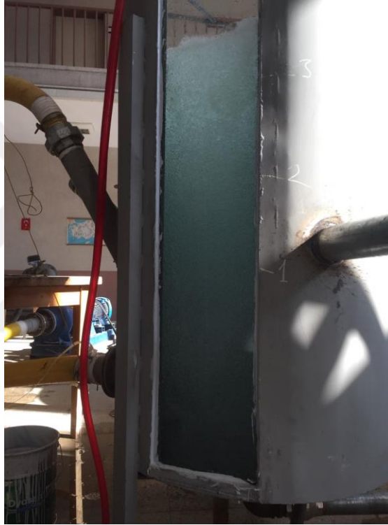
Şekil 3.1.1.1.c K=10\% konduit daralması, \alpha=60 derece saplanma açısı ve L=1,5 m konduit boyu ile kurulan deney düzeneğinin flotasyon kolonu içerisinde oluşturmuş olduğu hava kabarcığı oluşumu.
