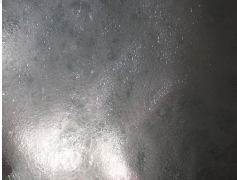
Şekil 3.1.1.1.i.a K=10\% konduit daralması, \alpha=60 derece saplanma açısı ve L=3 m konduit boyu ile kurulan deney düzeneğinin flotasyon kolonu içerisinde oluşturmuş olduğu hava kabarcığı oluşumunun üstten görünüm
