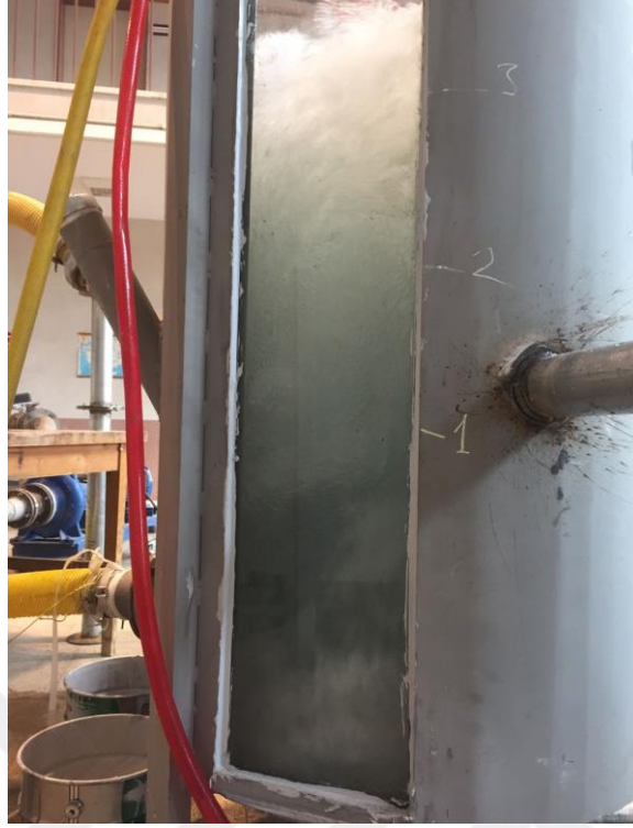
Şekil 3.1.2.1.h L=1,5 m konduit boyu, \alpha=45 derece saplanma açısı ve K=\%40 konduit daralması ile kurulan deney düzeneğinin flotasyon kolonu içerisinde oluşturmuş olduğu hava kabarcığı oluşumu.
