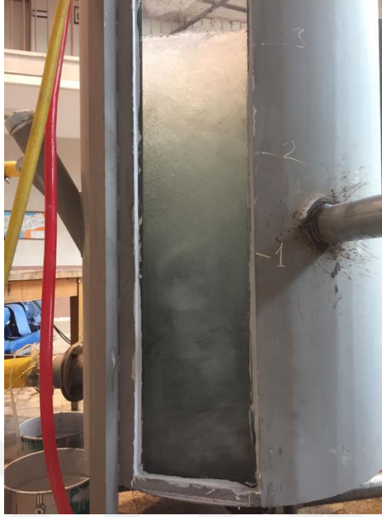
Şekil 3.1.3.1.i \alpha=30 derece saplanma açısı, L=3 m konduit boyu, ve K=\%40 konduit daralması ile kurulan deney düzeneğinin flotasyon kolonu içerisinde oluşturmuş olduğu hava kabarcığı oluşumu.
