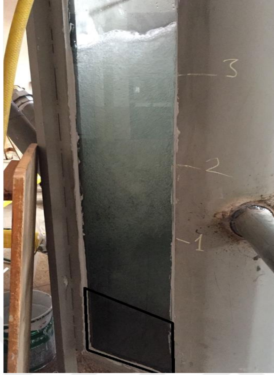
Şekil 3.1.3.1.d \alpha=45 derece saplanma açısı, L=2 m konduit boyu, ve K=\%10 konduit daralması ile kurulan deney düzeneğinin flotasyon kolonu içerisinde oluşturmuş olduğu hava kabarcığı oluşumu.
