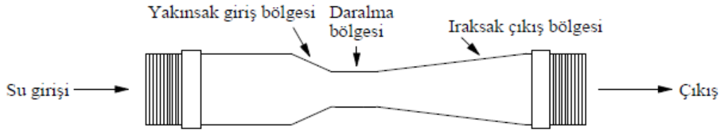
Şekil 1.2. Bir venturi aygıtının görünümü (Özkan, 2005).
