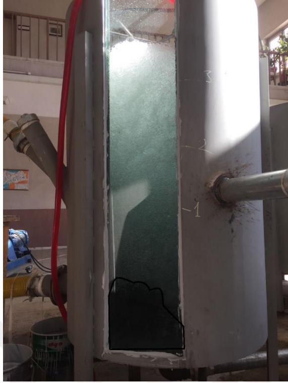
Şekil 3.1.3.1.g \alpha=45 derece saplanma açısı, L=3 m konduit boyu, ve K=\%10 konduit daralması ile kurulan deney düzeneğinin flotasyon kolonu içerisinde oluşturmuş olduğu hava kabarcığı oluşumu.
