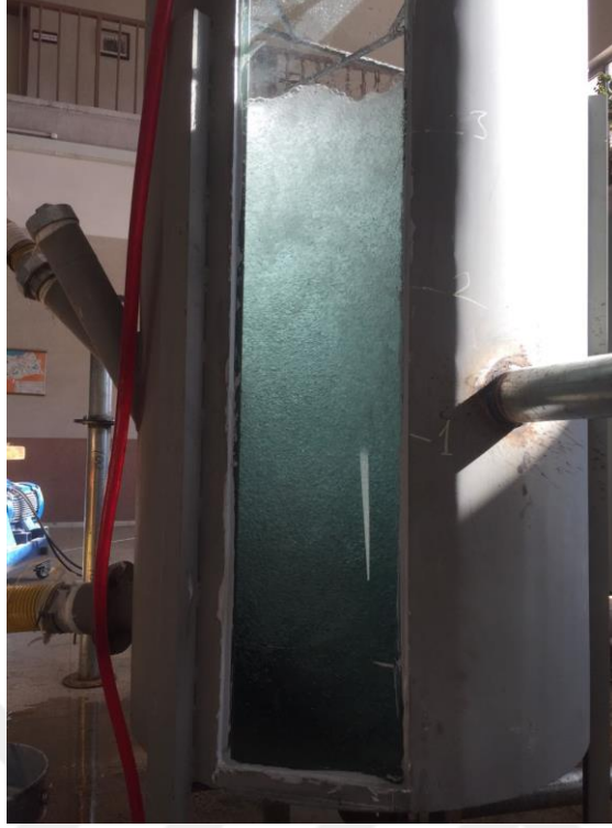
Şekil 3.1.1.1.b K=\%10 konduit daralması, \alpha=45 derece saplanma açısı ve L=1,5 m konduit boyu ile kurulan deney düzeneğinin flotasyon kolonu içerisinde oluşturmuş olduğu hava kabarcığı oluşumu.
