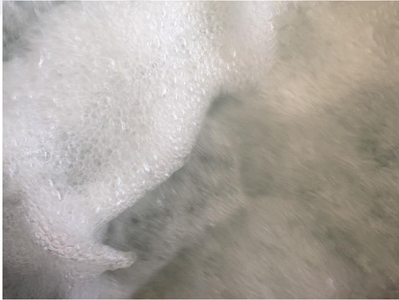
Şekil 3.1.1.1.g.a K=\%10 konduit daralması, \alpha=30 derece saplanma açısı ve L=3 m konduit boyu ile kurulan deney düzeneğinin flotasyon kolonu içerisinde oluşturmuş olduğu hava kabarcığı oluşumunun üstten görünümü
