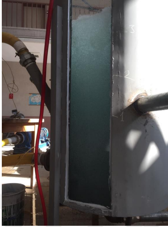
Şekil 3.1.3.1.a \alpha=60 derece saplanma açısı, L=1,5 m konduit boyu, ve K=\%10 konduit daralması ile kurulan deney düzeneğinin flotasyon kolonu içerisinde oluşturmuş olduğu hava kabarcığı oluşumu.
