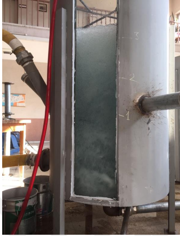
Şekil 3.1.2.1.i L=1,5 m konduit boyu, \alpha=60 derece saplanma açısı ve K=\%40 konduit daralması ile kurulan deney düzeneğinin flotasyon kolonu içerisinde oluşturmuş olduğu hava kabarcığı oluşumu.
