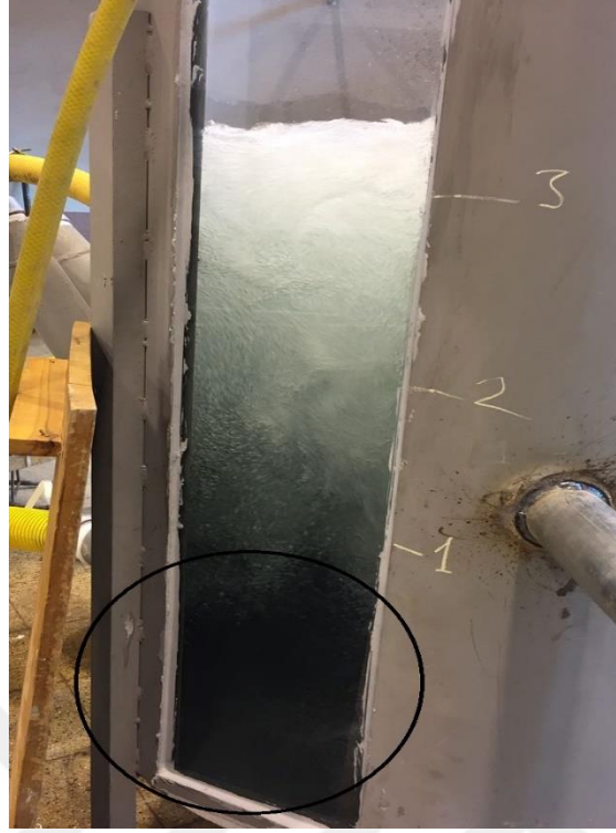
Şekil 3.1.1.1.d K=10\% konduit daralması, \alpha=30 derece saplanma açısı ve L=2 m konduit boyu ile kurulan deney düzeneğinin flotasyon kolonu içerisinde oluşturmuş olduğu hava kabarcığı oluşumu ve ölü bölge tesbiti.
