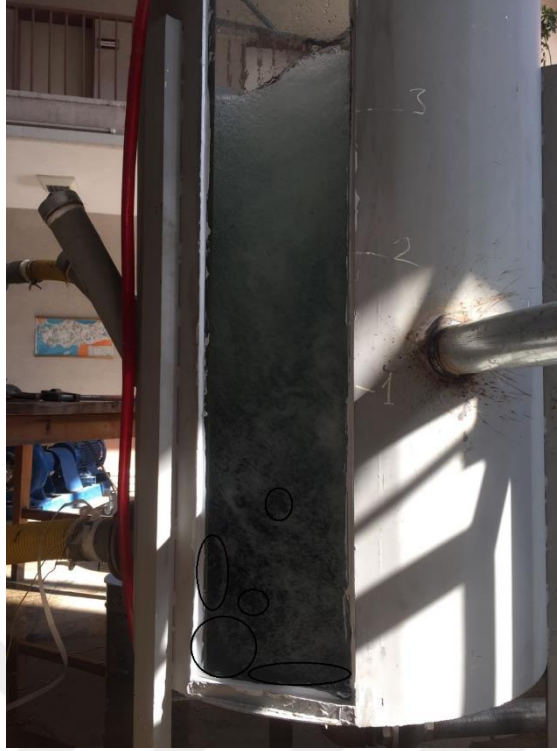
Şekil 3.1.1.1.g K=\%10 konduit daralması, \alpha=30 derece saplanma açısı ve L=3 m konduit boyu ile kurulan deney düzeneğinin flotasyon kolonu içerisinde oluşturmuş olduğu hava kabarcığı oluşumu.
