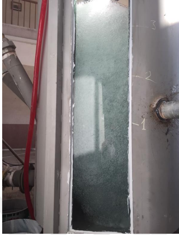
Şekil 3.1.1.1.i K=10\% konduit daralması, \alpha=60 derece saplanma açısı ve L=3 m konduit boyu ile kurulan deney düzeneğinin flotasyon kolonu içerisinde oluşturmuş olduğu hava kabarcığı oluşumu
