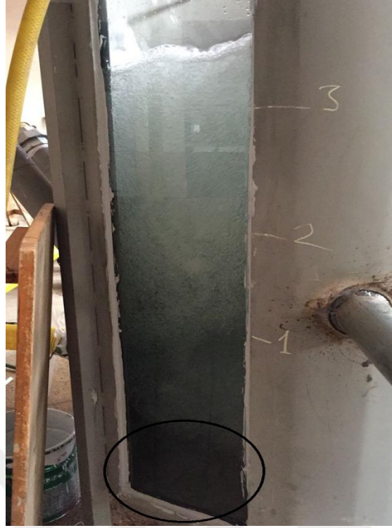
Şekil 3.1.1.1.e K=10\% konduit daralması, \alpha=45 derece saplanma açısı ve L=2 m konduit boyu ile kurulan deney düzeneğinin flotasyon kolonu içerisinde oluşturmuş olduğu hava kabarcığı oluşumu.
